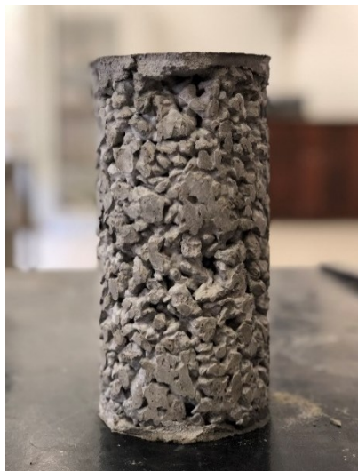
Figura 25. Corpo de prova capeado com argamassa
