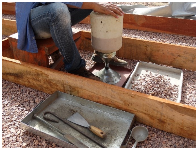
Figura 64. Execução do ensaio de cone de areia
