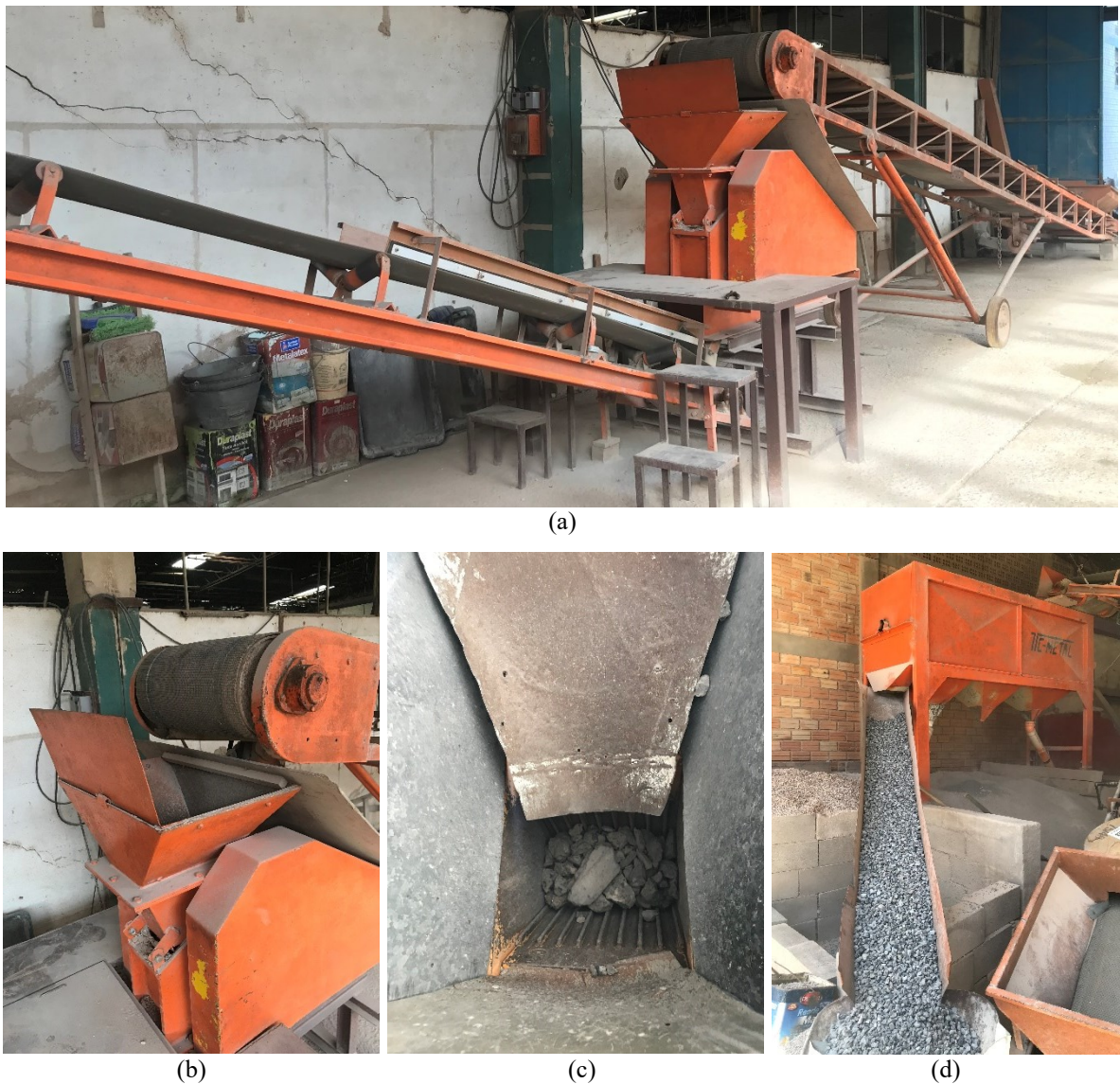
Figura 8. Beneficiamento do agregado reciclado de concreto: (a) aspecto geral do britador; (b) britador de mandíbula parte externa; (c) britador de mandíbula parte interna e (d) coleta do material após passar pelo peneirador
