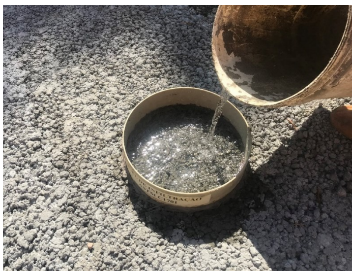
Figura 62. Ensaio de determinação da taxa de infiltração in situ
