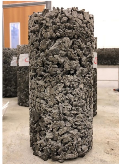
Figura 21. Aparência do corpo de prova compactado em duas camadas
