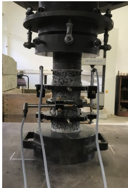
Figura 18. Ensaio de módulo de elasticidade estático e coeficiente de Poisson
