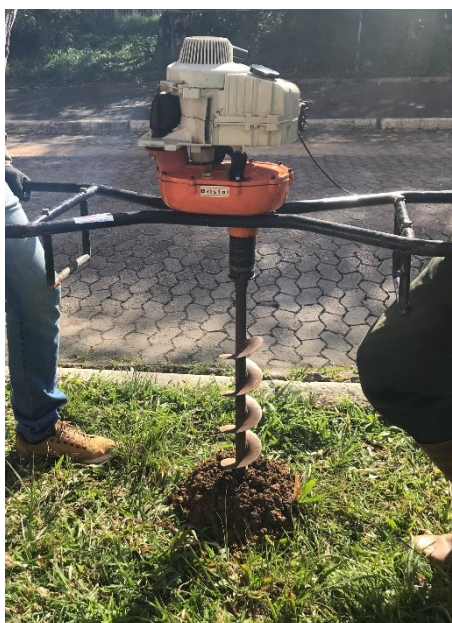
Figura 44. Sondagem a trado para a caracterização do solo
