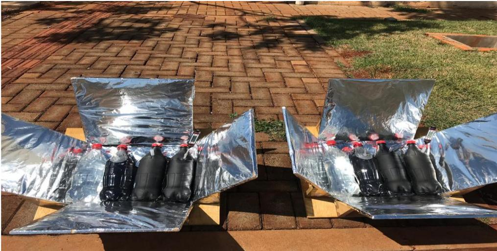
**Figura 1: Garrafas expostas a radiação no concentrador solar SODIS.**
