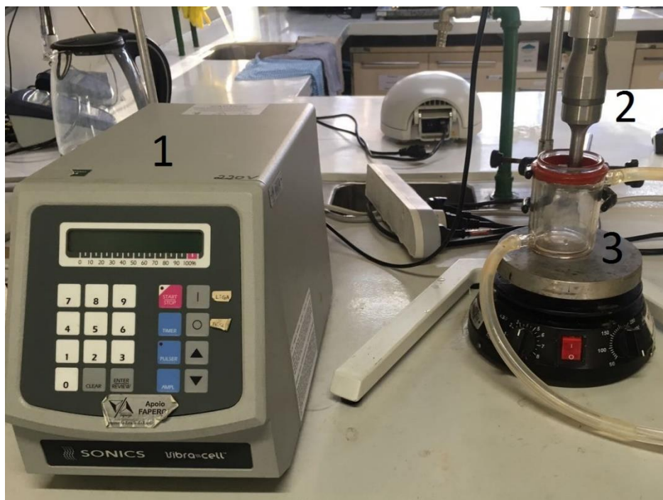
Figura 4.2: Aparato experimental utilizado no pré-tratamento: 1) Aparelho de ultrassom; 2) Sonda de ultrassom; 3) Célula encamisada para o pré-tratamento e agitador magnético.
