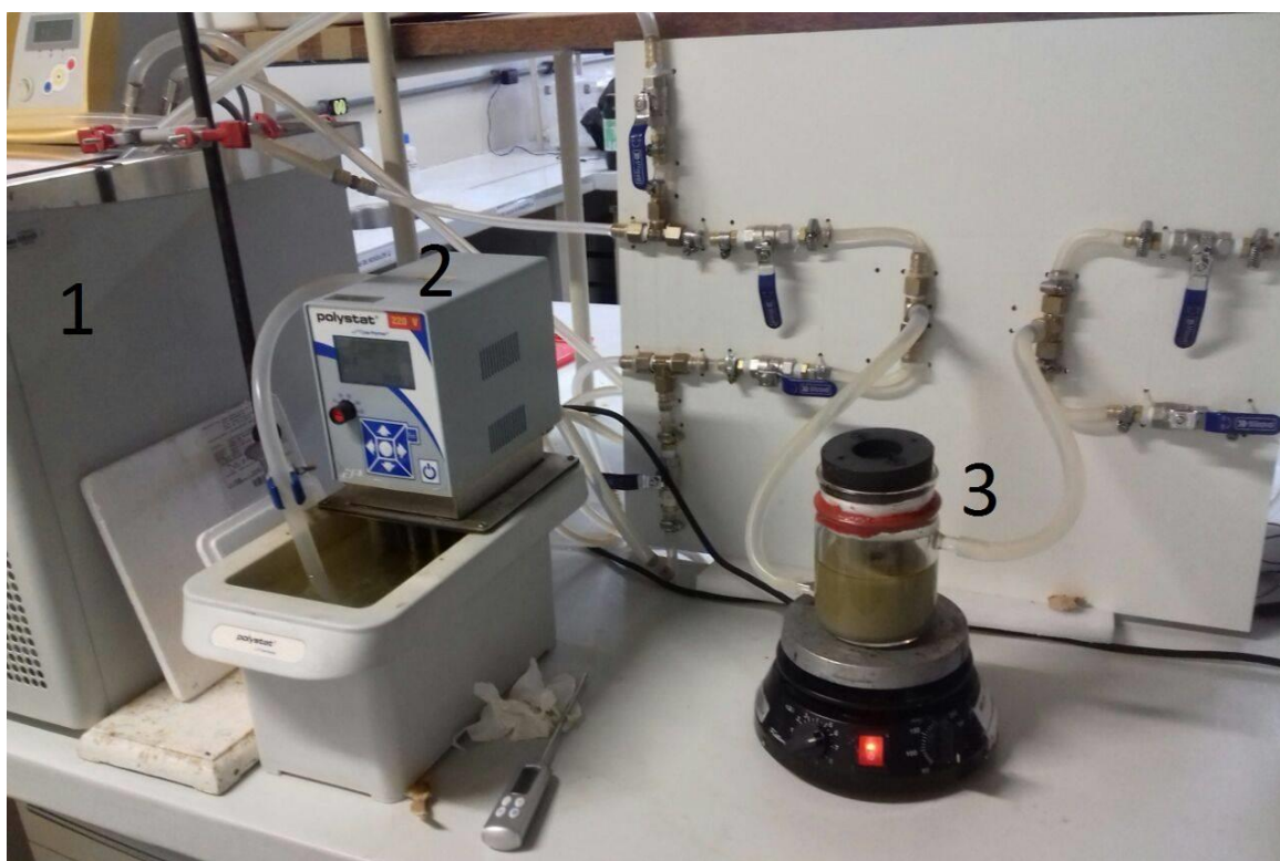
Figura 4.3: Aparato experimental utilizado na etapa difusiva: 1) Banho de resfriamento; 2) Banho de aquecimento; 3) Célula de extração utilizada na etapa difusiva.
