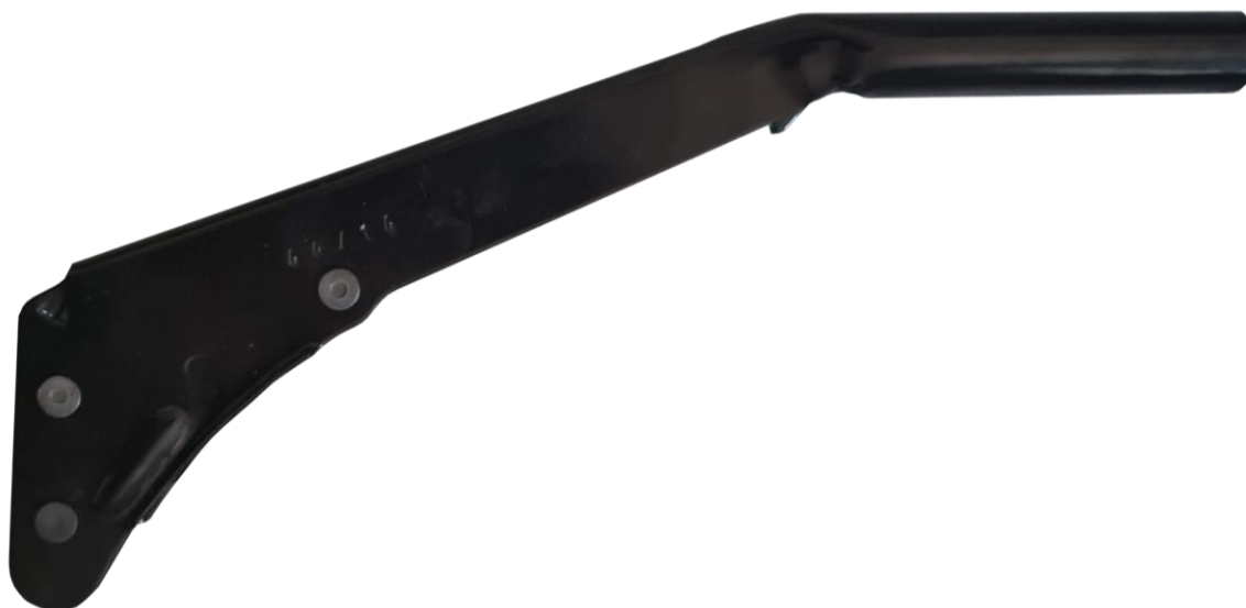
Figura 3 – Alavanca de freio de estacionamento do VW Gol G4. Fonte: O autor.
