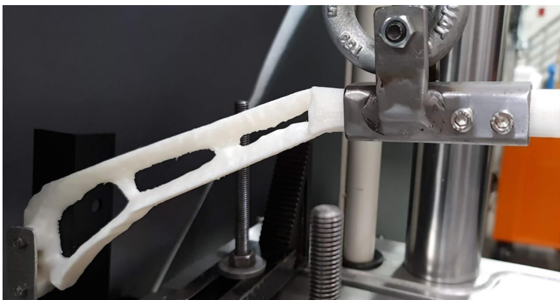
Figura 9 – Amostra posicionada na bancada de tração. Fonte: O autor.
