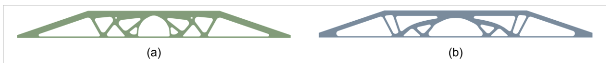
Figura 7- Topologias finais para retenção de massa em 35% com restrição de tensão de (a) 15MPa e (b) 10MPa.
