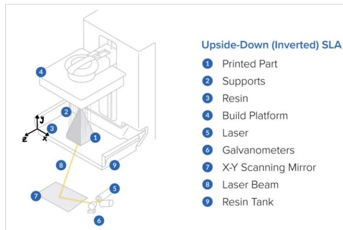
Figura 2- Principais componentes e esquema de funcionamento geral de impressoras 3D SLA.
