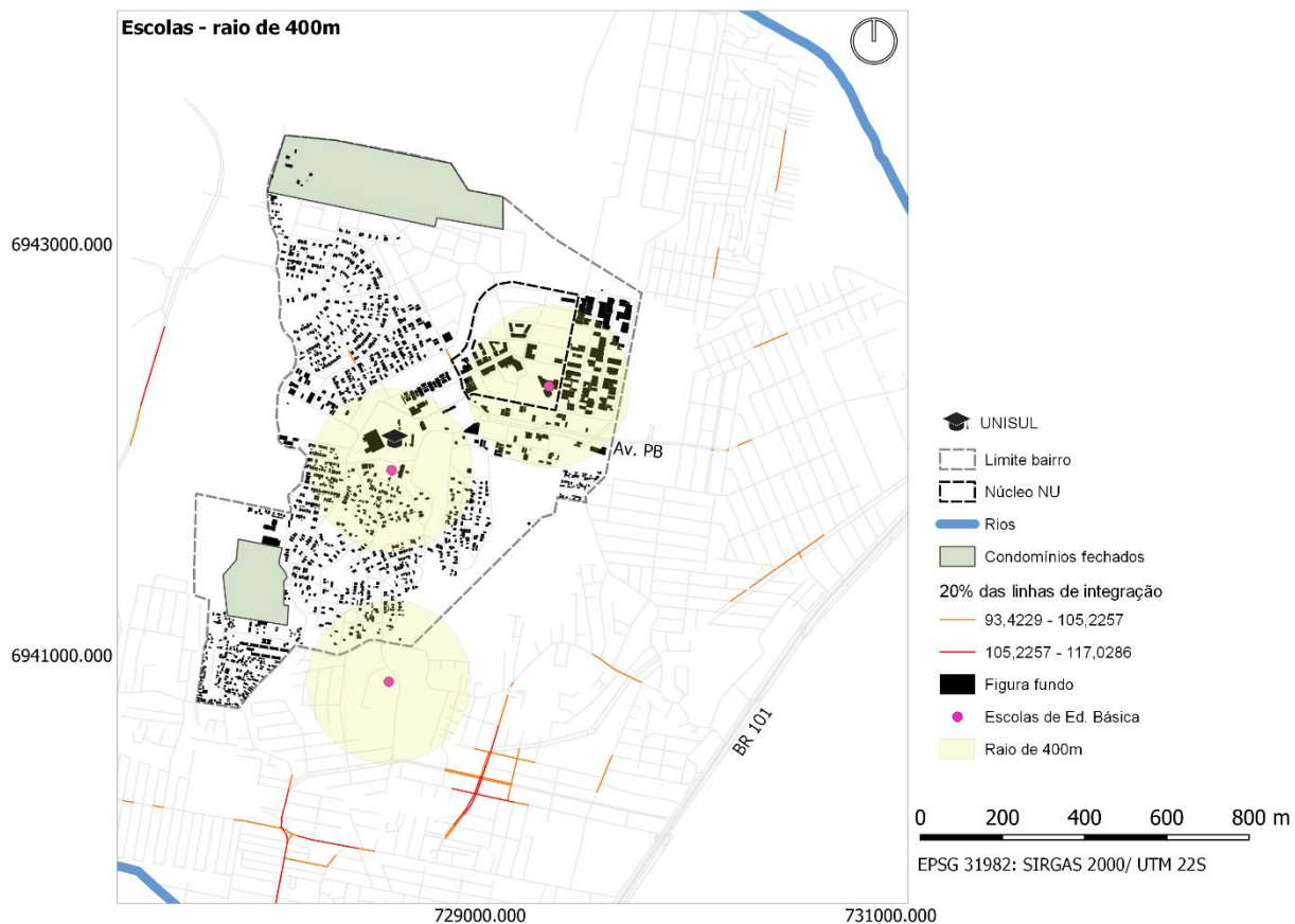
Figura 91: Raio de abrangência das escolas existentes, com destaque aos 20% dos segmentos mais integrados. Base do mapa: segmentado, integração local R400.
