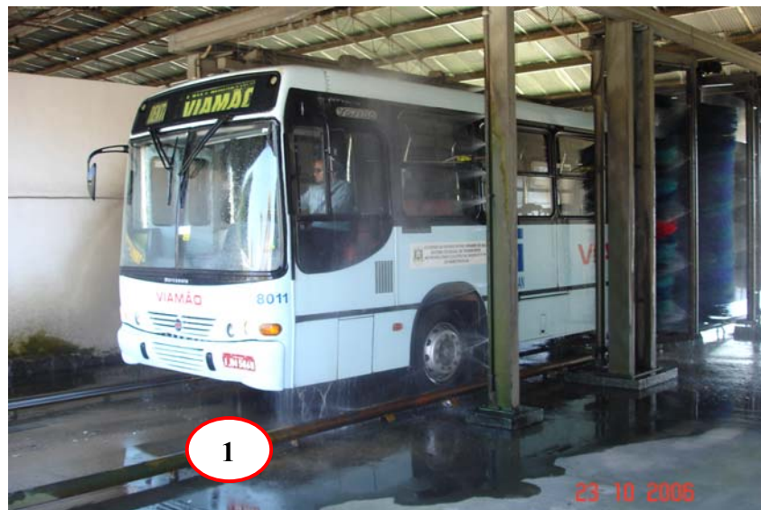
Figura 5. Ponto de lavagem mecanizado (tipo roll-over ). 1 – Calha para coleta da água residuária.
