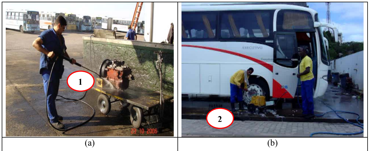
Figura 4. Pontos de lavagem manual. (a) Lavagem de partes mecânicas / peças em manutenção e (b) lavagem interna e das rodas. 1 – Ralo para coleta de água residuária e 2 – calha para coleta de água residuária.
