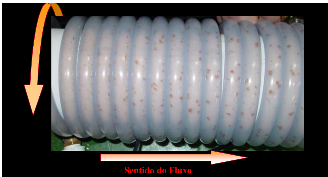
Figura 12. Fotografia do RGF em escala de bancada, mostrando o crescimento dos flocos ao longo do seu eixo longitudinal.
