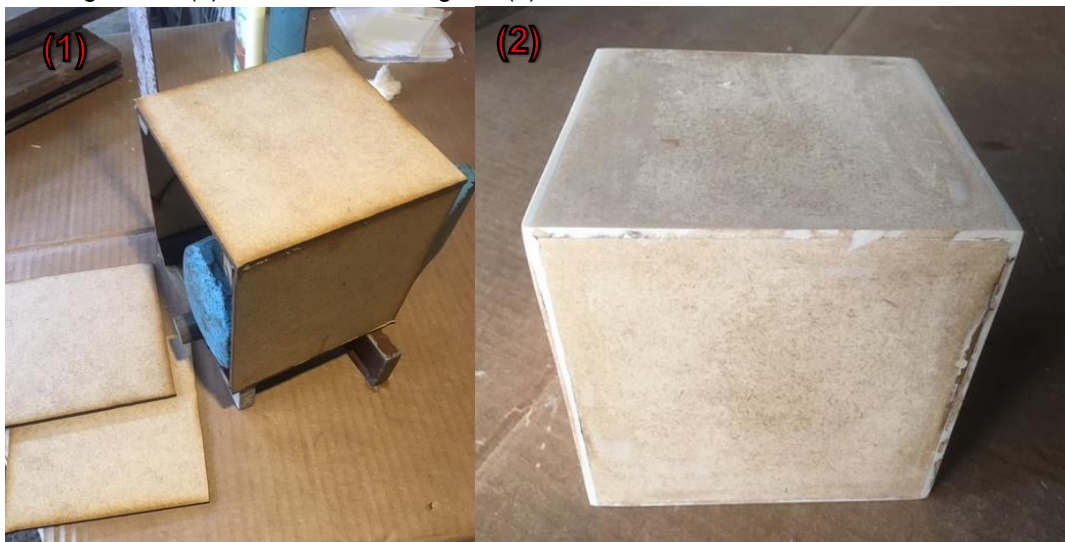
Figura 53: (1) Processo de Colagem; (2) Modelo Montado e com Massa Plástica.
