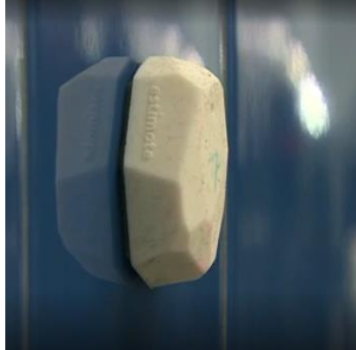
Figura 13: Balizas instaladas nas estações.
