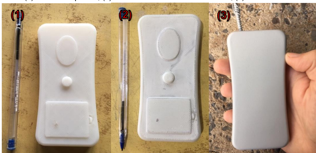
Figura 70: (1) Produto Impresso; (2) Acabamento com Massa Plástica; (3) Acabamento com Primer;
