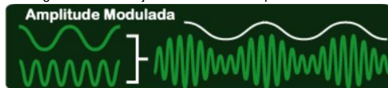
Figura 28: Modulação de Onda Por Amplitude Modulada.
