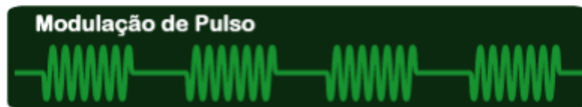
Figura 27: Modulação de Onda Por Pulso.
