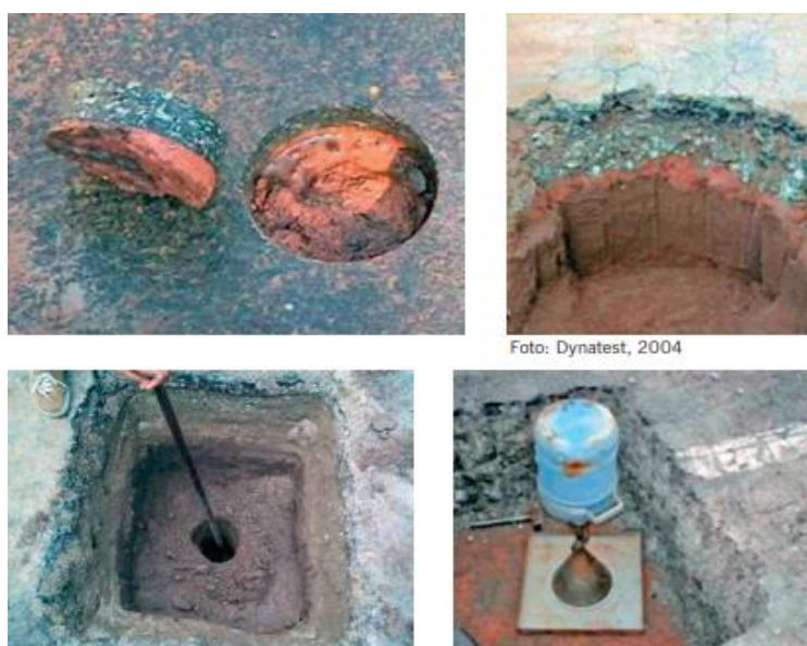
Figura 6 - Extração de amostras de corpos de prova
