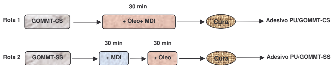
Figura 21: Esquema das rotas de obtenção dos adesivos PU/GOMMT – Procedimento 2.
