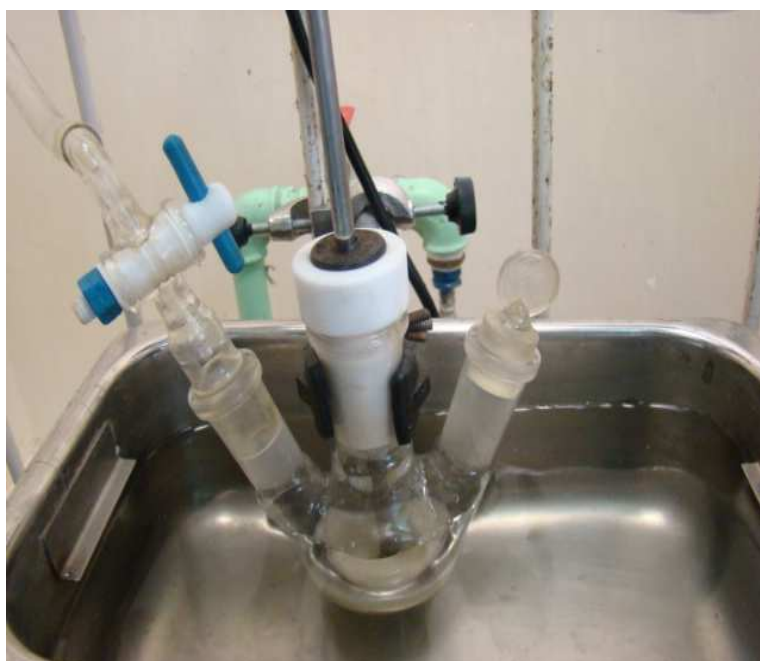
Figura 18: Imagem fotográfica do sistema reacional utilizado na síntese do adesivo de PU.
