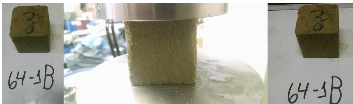
Figura 4-5 Amostra de compressão simples antes (esquerda) e depois da ruptura (centro e direita) com força aplicada paralelamente a compactação.
