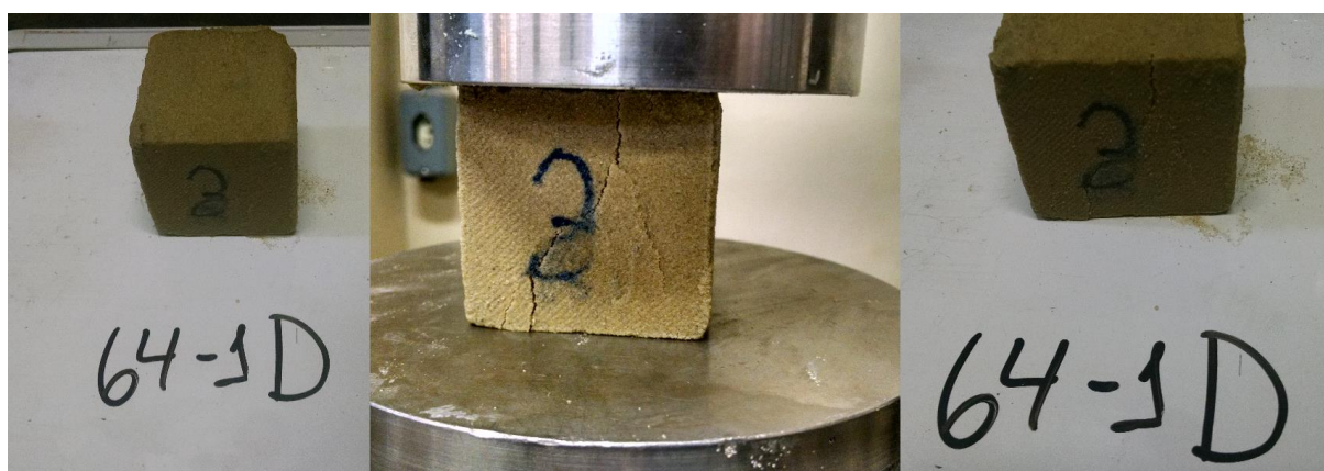
Figura 4-5 Amostra de compressão simples antes (esquerda) e depois da ruptura (centro e direita) com força aplicada paralelamente a compactação.
