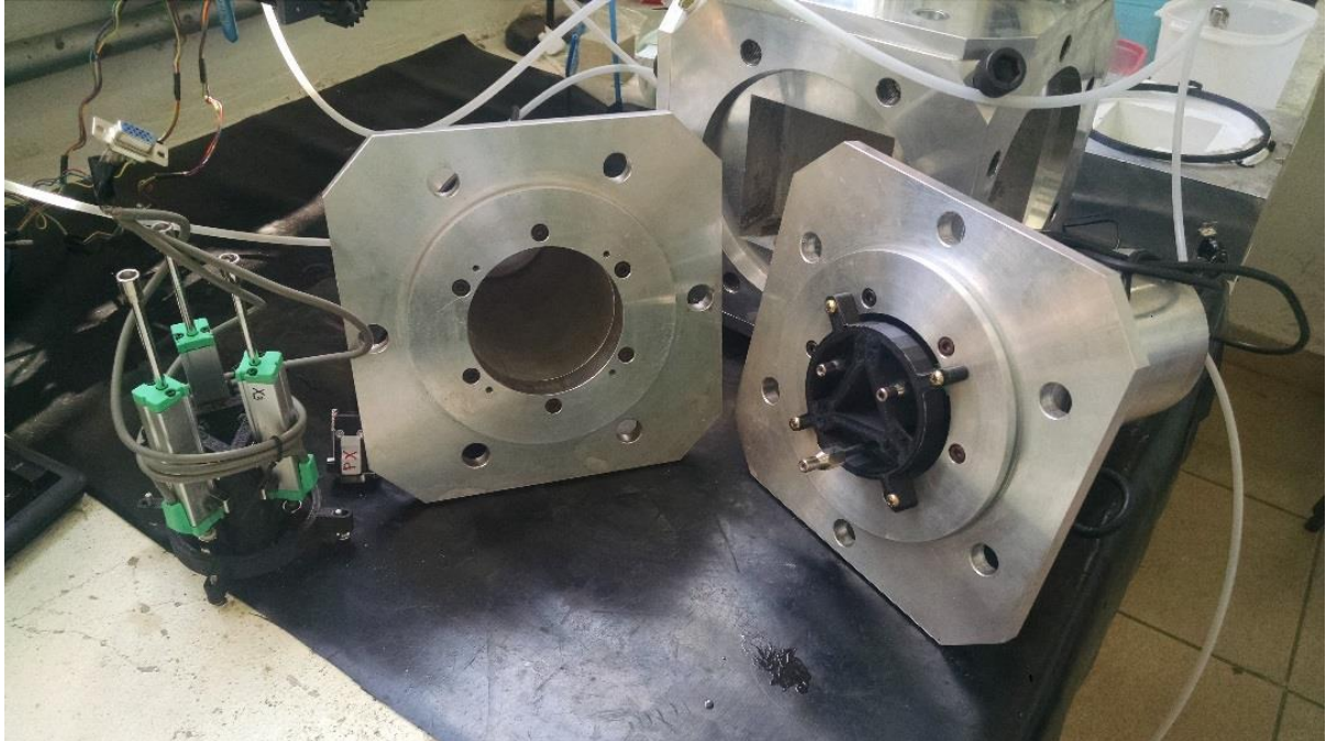
Figura 3-15 Suporte com LVDTs (esquerda), tampa flexível (centro), conjunto montado (direita).
