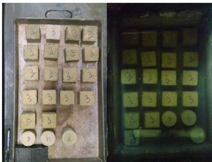
Figura 4-4 Amostras de compressão simples. Esquerda amostras antes da imersão com 6 dias de cura e direita saturadas com 7 dias de cura prontas para ruptura.
