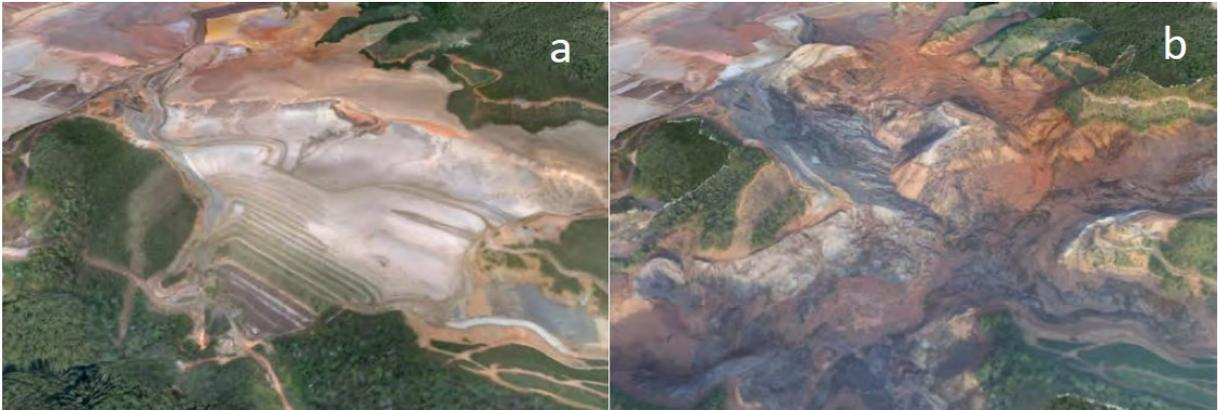
Figura 2.8 – Barragem de Fundão e reservatório antes (a) e depois (b) da ruptura (MORGENSTERN *et al.*, 2016)
