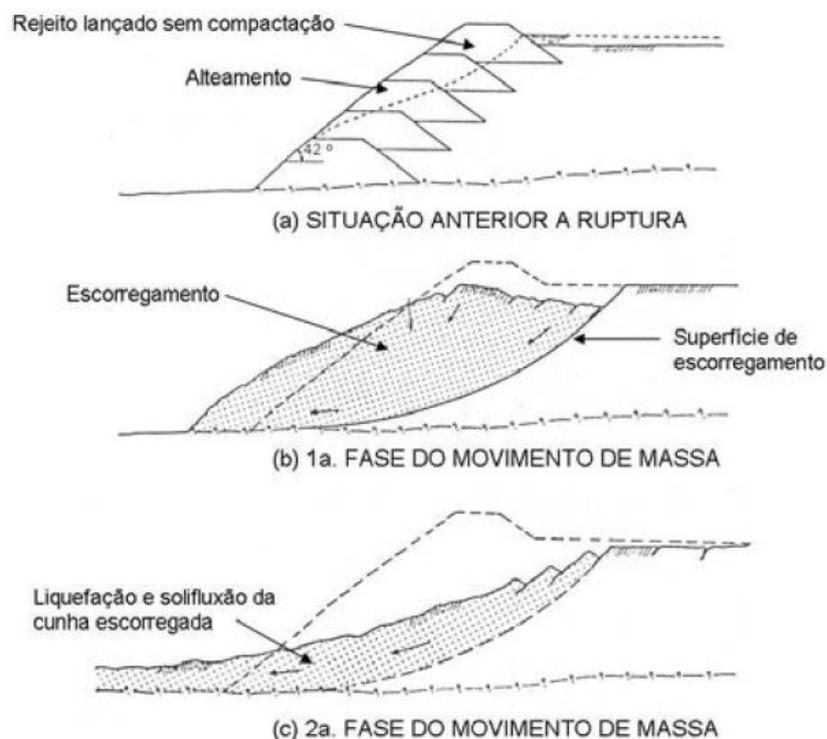
Figura 2.7 – Fases da ruptura da barragem de contenção da Mina de Fernandinho (PARRA & LASMAR, 1987)
