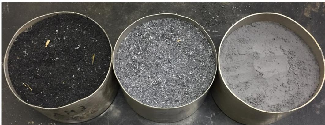
Figura 2.11 – Cinza de casca de arroz *in natura* (esquerda), submetida à tratamento térmico (centro) e submetido à tratamento combinado (térmico + físico) (direita) (SERVI *et al.*, 2019a)
