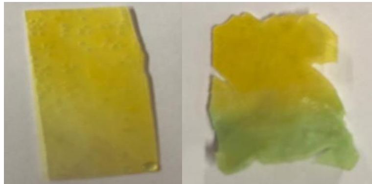
Figura 16 – Fotografia dos filmes de PLA (PLA20) e de amido de milho (AMI20).
