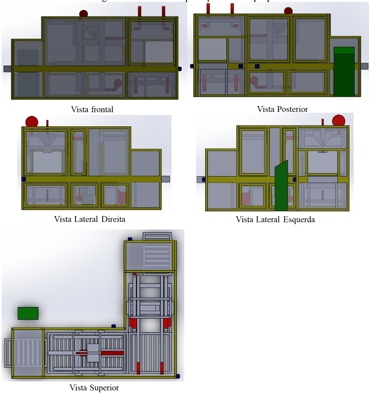
Figura 10 – Vistas das proteções físicas propostas
