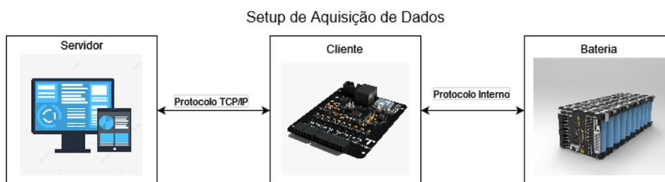
**Figura 10:** Sistema servidor-cliente e bateria.
