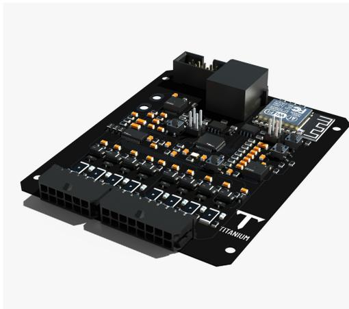
**Figura 9:** Placa de gerenciamento de baterias Titanium.
