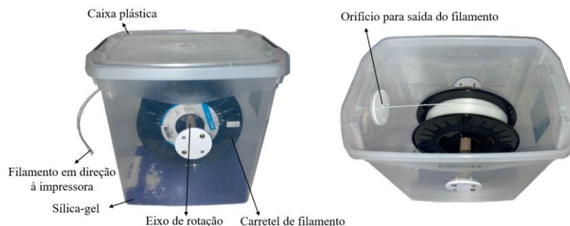
Figura 4.3 – Caixa de armazenamento do filamento durante a impressão.
