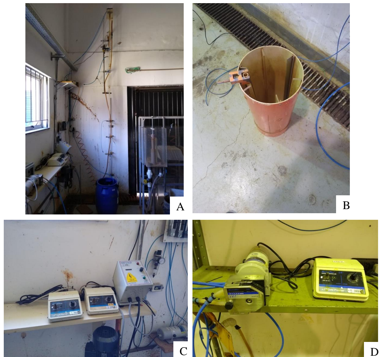
Figura 23 - Coluna de flotação de 1" e 4 metros de altura (A), tanque de polpa (B), e bombas peristálticas (C e D).
