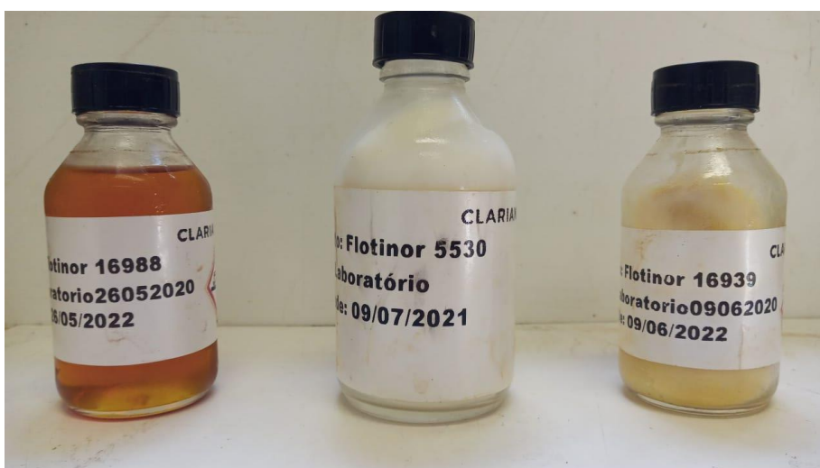
Figura 15 - Coletores Flotador 5530, Flotador 16939 e Flotador 16988 à temperatura de 5°C.
