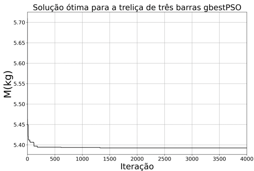
Figura 5.14 – Solução ótima – treliça de três barras do algoritmo em python gbest PSO.
