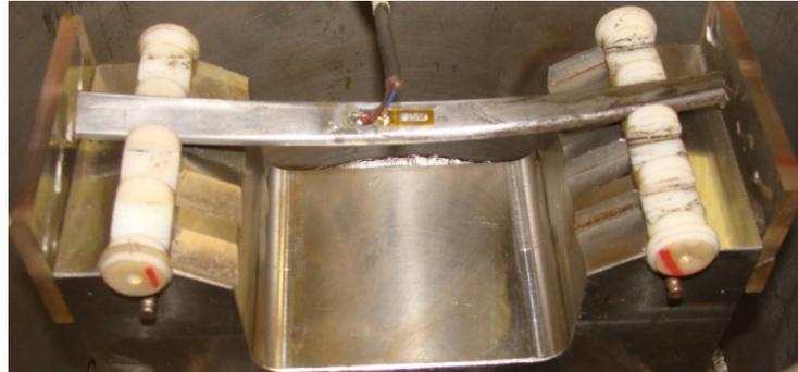
Figura 4.13 - Posicionamento do sensor na amostra.
