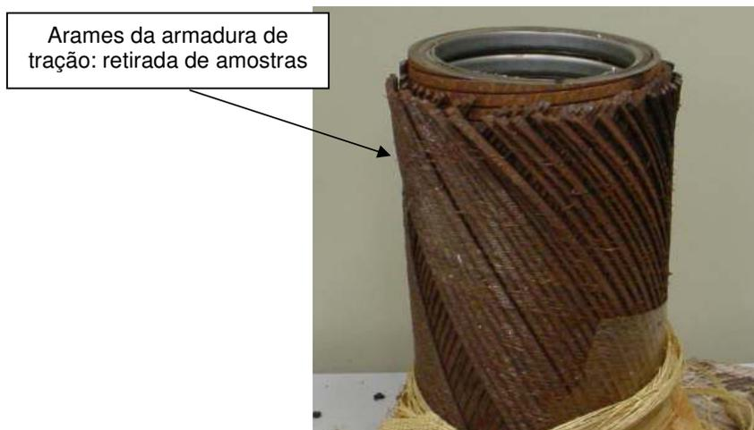
Figura 4.1 - Armadura de tração de um riser flexível: local de retirada de amostras.
