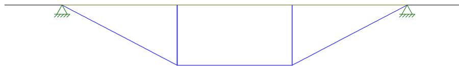
Figura 4.4 - Perfil do momento fletor a que o corpo de prova é submetido durante o ensaio de flexão a 4 pontos.
