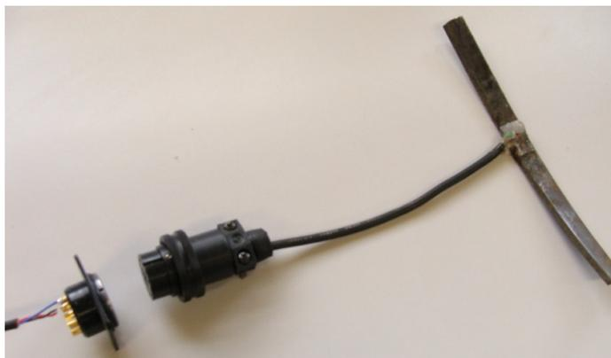
Figura 4.15 – Conector multiaxial utilizado para a conexão dos extensômetros e resina para proteção do extensômetro.
