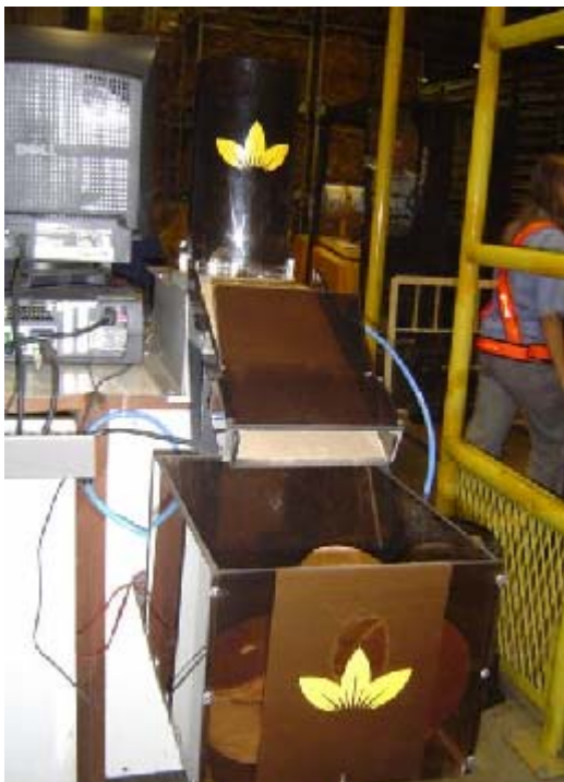
Figura 10 – Leitura das etiquetas de Rfid presas nas gaiolas Fonte: Material fornecido pela empresa Souza Cruz
