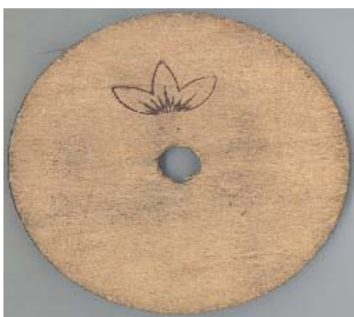
Figura 3 – Disco de madeira contendo etiqueta de Rfid Fonte: Material fornecido pela empresa Souza Cruz
