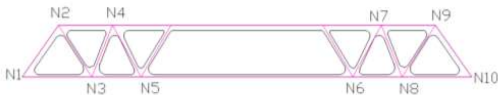
Fig. 9. Geometria da nova viga otimizada (em rosa) com a sobreposição do traçado da treliça plana (em preto).
