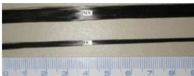
Fig. 1. Comparativo dos fios 3k e 12k de fibra de carbono. (AWBK, 2022).
