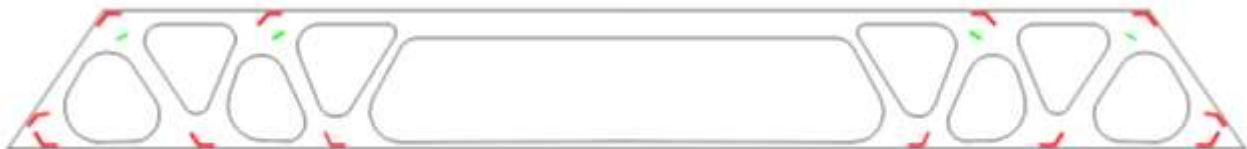
Fig. 12. Geometria final da viga com otimização topológica e sistema de ancoragem aprimorado.
