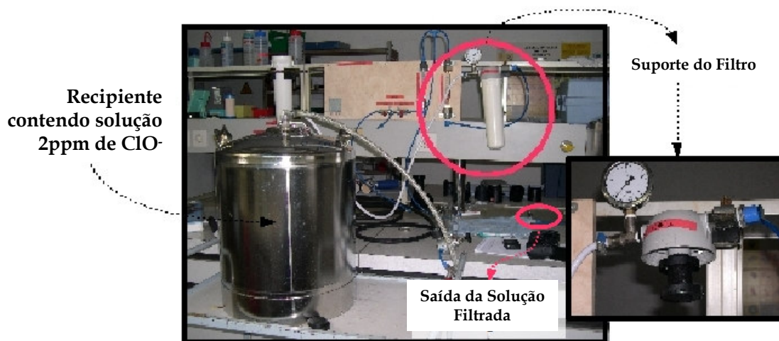
Figura 10: Sistema utilizado para o ensaio de redução de hipoclorito.
