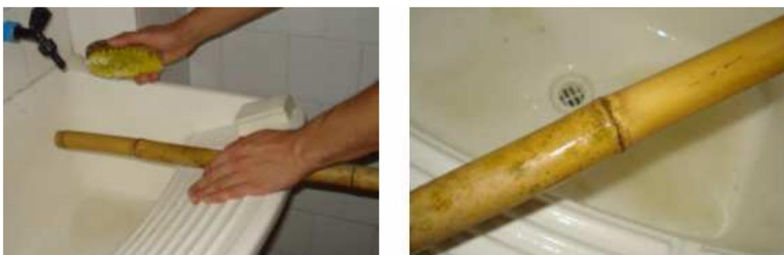
**Figura 22: Limpeza das varas de Bambu (E), vara de bambu parcialmente limpa (D).**
