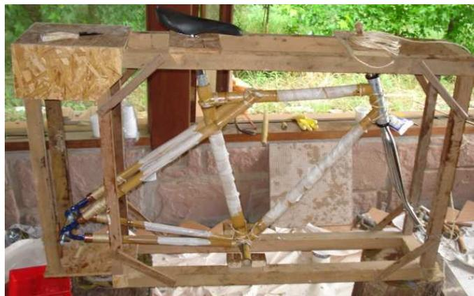
**Figura 41: Isolamento de partes do quadro a fim de evitar o contato com a resina.**
