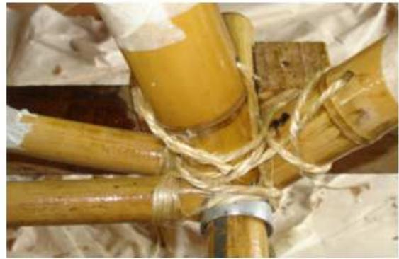
**Figura 40: Detalhe da pré-amarração realizada no quadro da bicicleta.**
