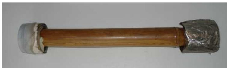
**Figura 26: Foto corpo de prova resinado para ensaio de torção.**
