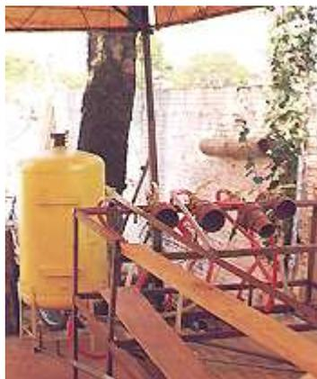
**Figura 6: Bomba de ar comprimido e sistema de mangueiras para boucherie.**
