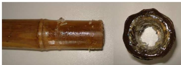
**Figura 31: Detalhe da região de descolamento da resina.**
