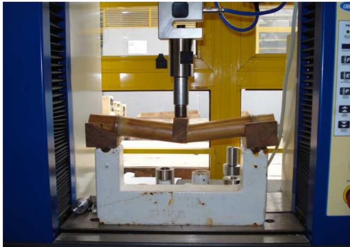
**Figura 28: Ensaio de Flexão no corpo de prova de bambu.**
