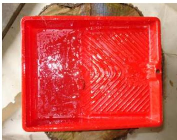
**Figura 39: Bandeja contendo a resina epóxi para imersão da fibra de sisal.**
