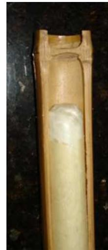
**Figura 37: Término do encaixe das peças de bambu do quadro da bicicleta (E) e preenchimento das cavidades internas do bambu com PU (D).**
