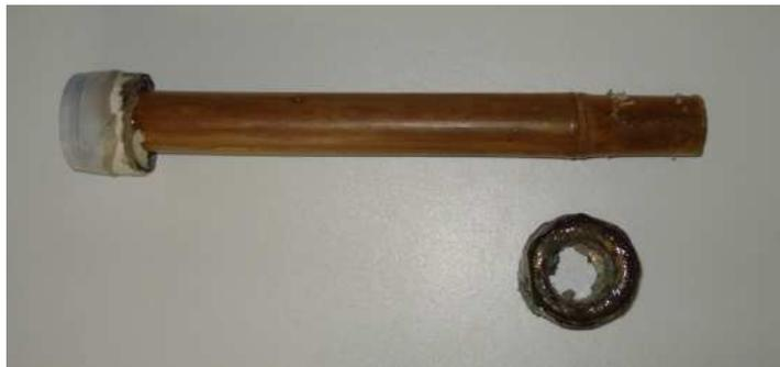
**Figura 30: Descolamento da resina no CP de bambu.**
