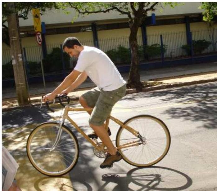
**Figura 44: Bicicleta de bambu pronta para o uso.**
