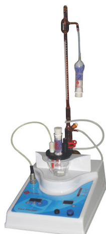
Figura 3.3: Aparelho Karl Fischer semiautomático utilizado nas análises de teor de água. Fonte: site Quimis.
