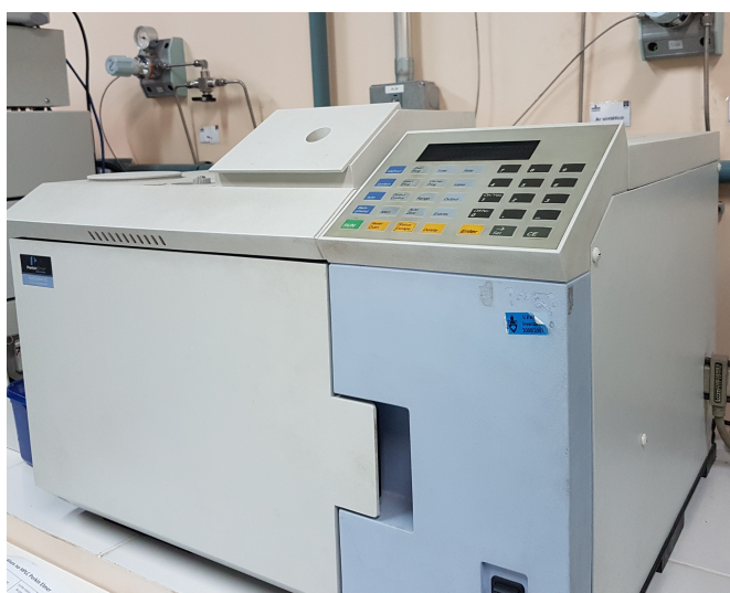
Figura 3.6: Cromatógrafo gasoso Perkin Elmer Auto System XL utilizado na determinação dos IDAC. Fonte: o autor.
