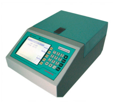
Figura 3.2: Medidor de atividade de água ( a_w ) LabMaster (Novasina). Fonte: o autor.
