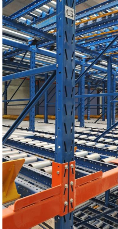
Figura 1.5 - Ligação viga-coluna de um sistema de armazenagem (Fonte: adaptado de ÁGUIA SISTEMAS, 2022)
