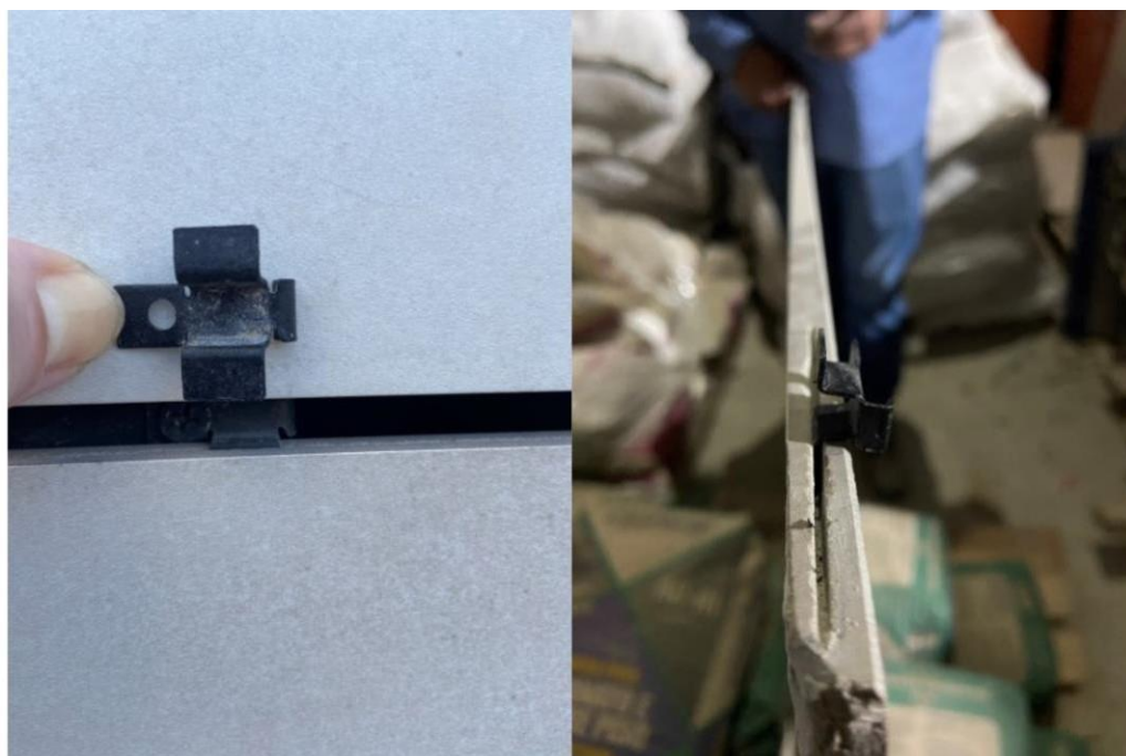
Figura 44 - Clipe de aço ensaiado da maneira que é fixado no perfil e no revestimento.
