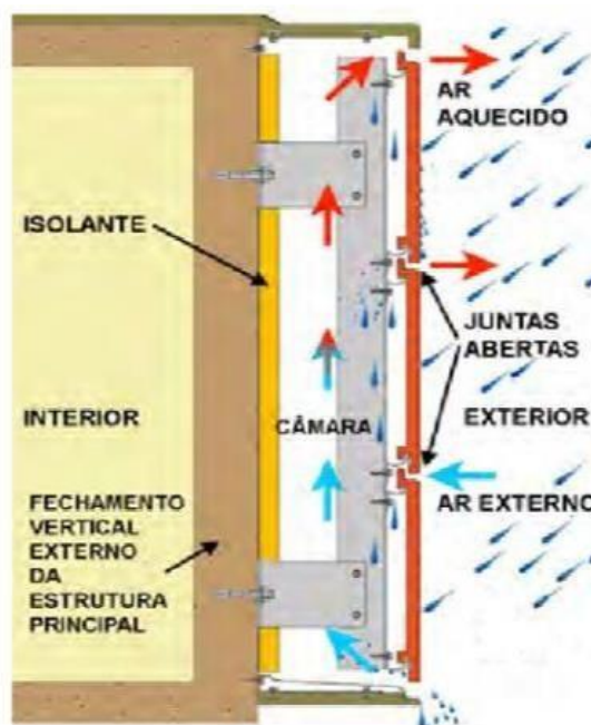
Figura 13 - Corte esquemático do sistema com juntas abertas e como funciona a câmara de ar e chuva.
