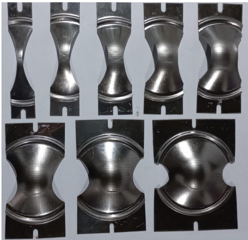
Figura 44 - Amostras de aço inox AISI 304 ensaiadas através de Nakazima modificado.
