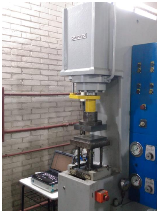
Figura 49 – Prensa hidráulica de duplo-efeito de marca Dan Presse.
