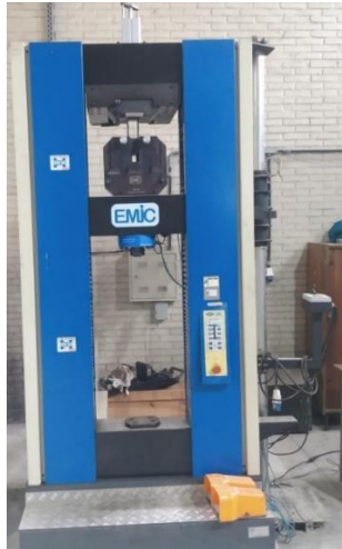
Figura 33 – Máquina universal de ensaios mecânicos, de marca EMIC, modelo DL 60.000.
