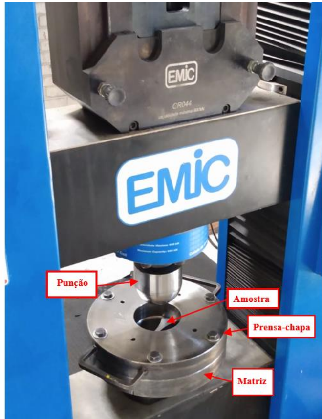
Figura 43 – Representação do ensaio Nakazima modificado executado na EMIC.
