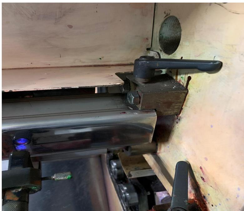
Figura 15: Zona de atrito com o lado esquerdo do suporte metálico do sensor de borda (lado direito).
