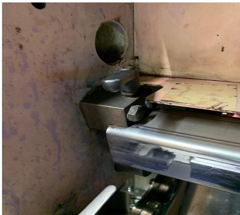
Figura 14: Zona de atrito com o lado esquerdo do suporte metálico do sensor de borda (lado esquerdo).
