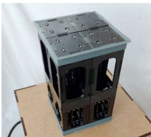
Figura 50: Display Braille de baixo custo com 16 pontos utilizando atuadores piezoelétricos
