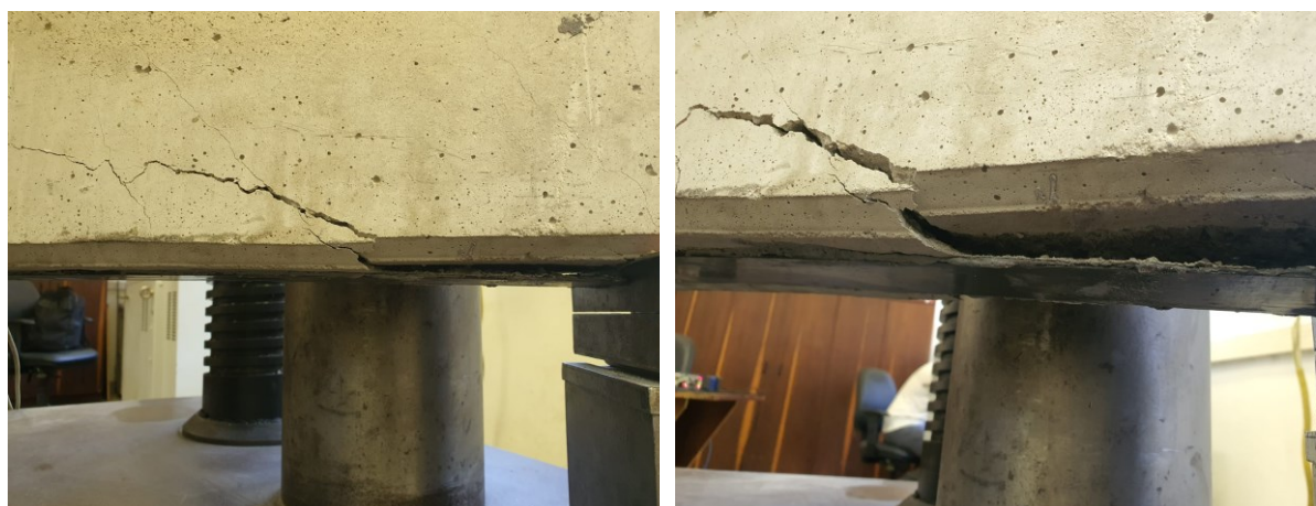
Figura 4.7 – Modo de falha da viga VS-1: descolamento do reforço
