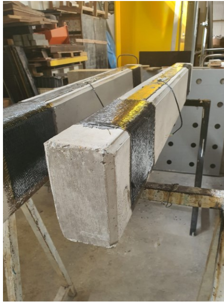
Figura 3.12 – Vigas simplesmente reforçadas com ancoragem de laço em U em posição de cura, com a superfície inferior voltada para cima
