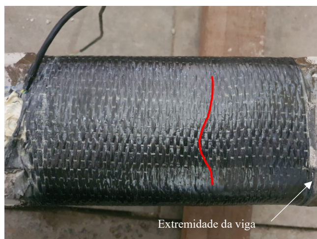
Figura 4.17 – Direcionamento lateral das fibras da ancoragem de laço em U
