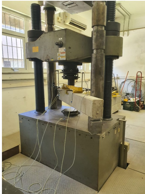
Figura 3.32 – Configuração do ensaio de flexão estática a quatro pontos
