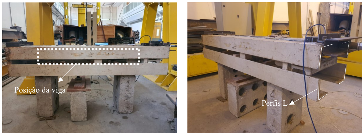
Figura 3.14 – Suporte externo de reação independente para o sistema de protensão
