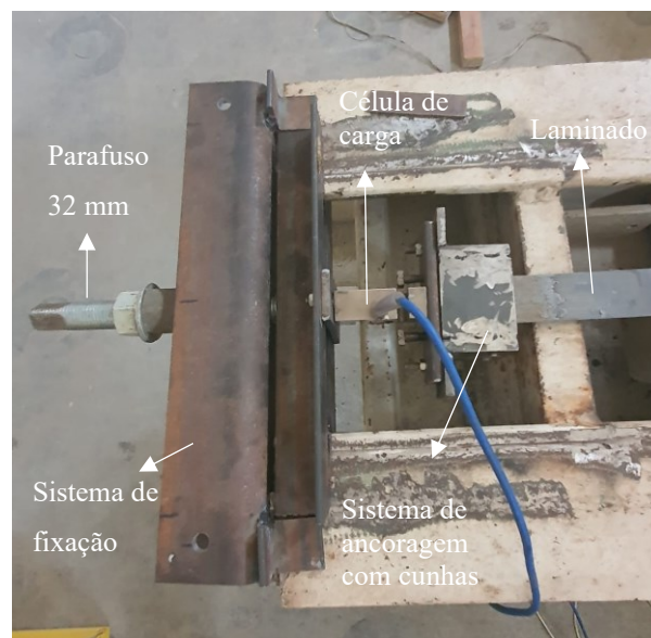
Figura 3.19 – Sistema completo da ancoragem ativa da protensão
