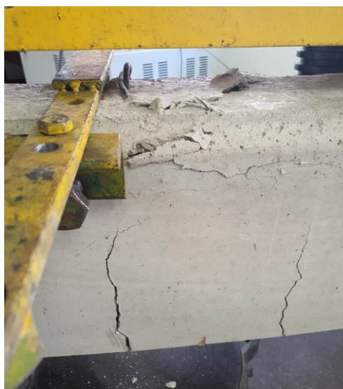
Figura 4.4 – Esmagamento a compressão do concreto das vigas testemunho
