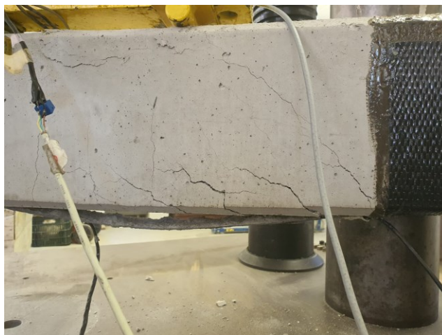
Figura 4.16 – Modo de ruptura da viga VPU-1: deslizamento do laminado com descolamento do substrato de concreto
