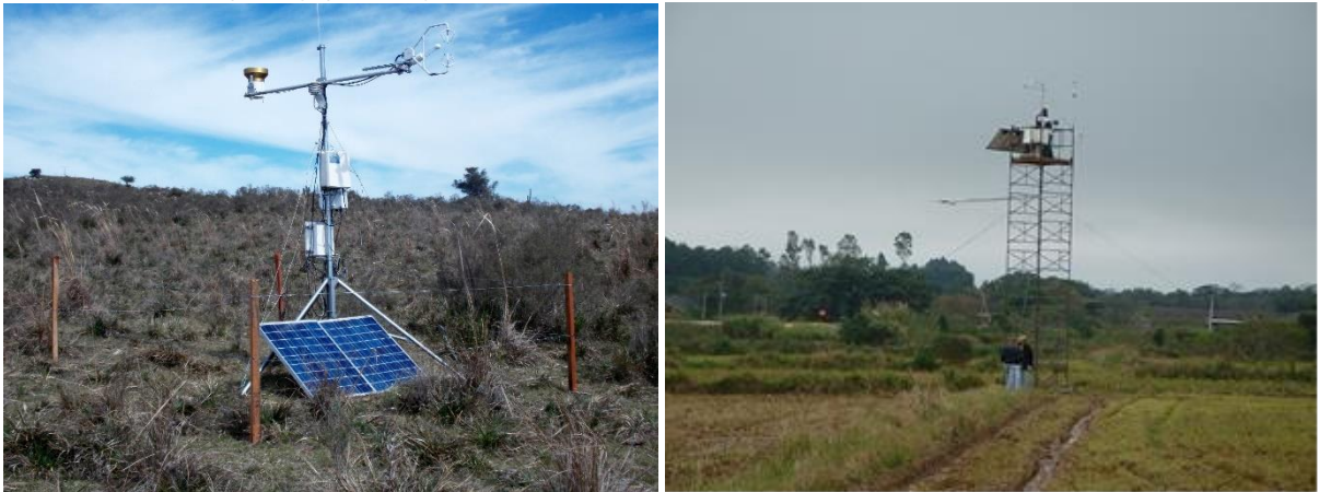
Figura 9 – Estações micrometeorológicas nos sítios de Pedras Altas (PAS) (Esquerda) e Paraíso do Sul (PRS) (Direita).
