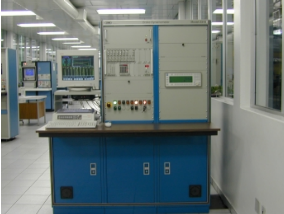
Fig 2.3.4 b – Vista da mesa de controle do dinamômetro de análise de ruído.
