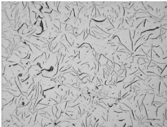
Figura 5.1.2: Microestrutura ferro fundido FC 150– Disco 2 (80X).
