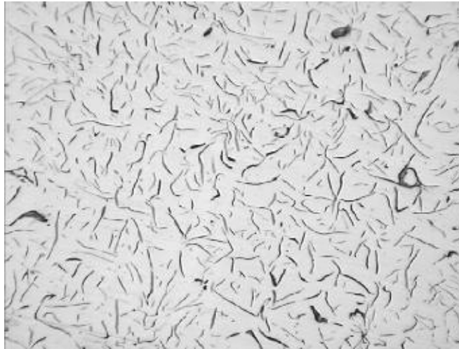
Figura 5.1.1: Microestrutura ferro fundido FC 250 – Disco 1 (80X).
