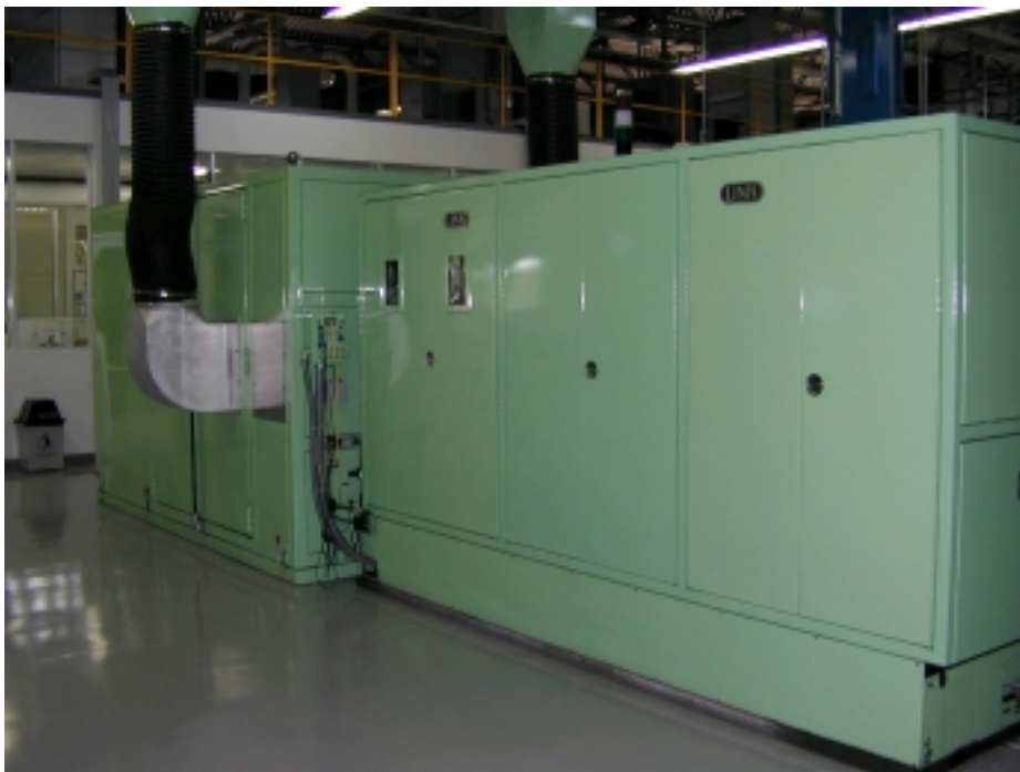
Fig 2.3.4 a – Vista externa de dinamômetro de análise de ruído.
