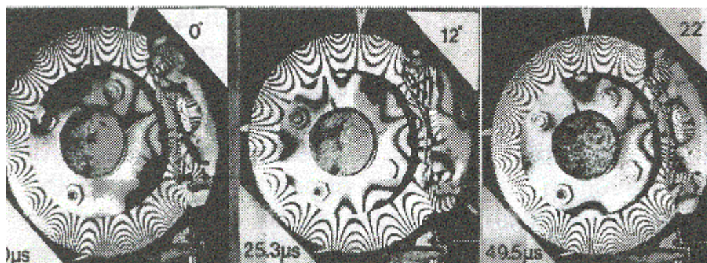
Figura 2.3.2 – Exemplo de imagens holográficas de modo de vibração de disco de freio.
