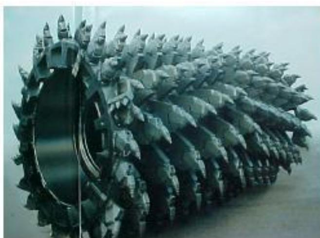
Figura 5: cilindro fresador (BONFIM, 2007)
