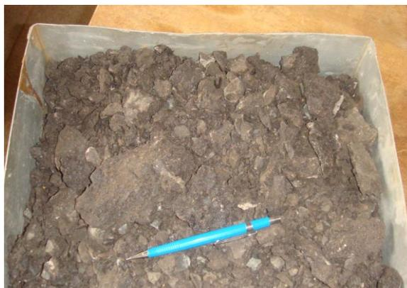
Figura 6: material asfáltico fresado (amostra 1)
