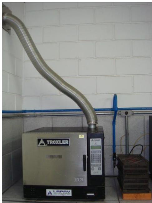
Figura 9: forno de ignição utilizado para determinação do teor de ligante presente nas amostras de material fresado
