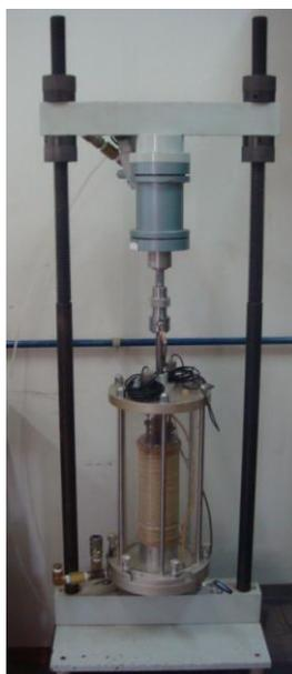
Figura 10: equipamento triaxial para ensaio de módulo de resiliência
