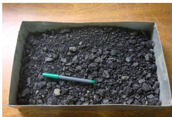
Figura 7: material asfáltico fresado (amostra 2)
