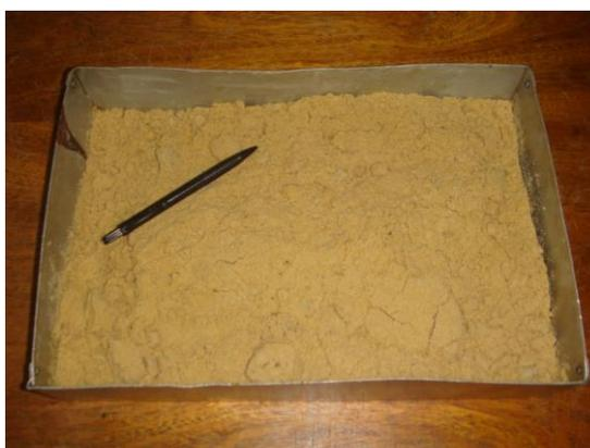
Figura 8: areia utilizada para comparação com o material asfáltico fresado
