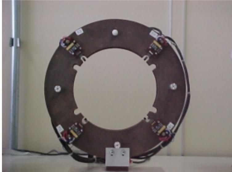
Figura 4.9 - Sistema de medição (Coroa de Sensores) – Vista frontal.
