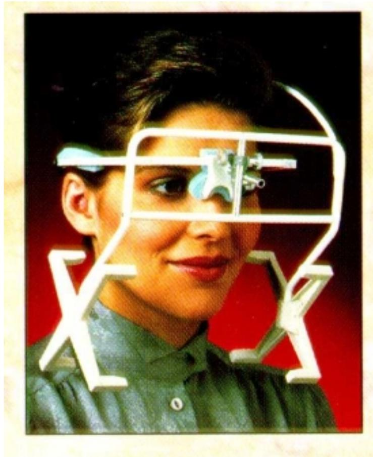
Figura 2.6 – Aparelho da Myo-Tronics para medir movimentos mandibulares.
