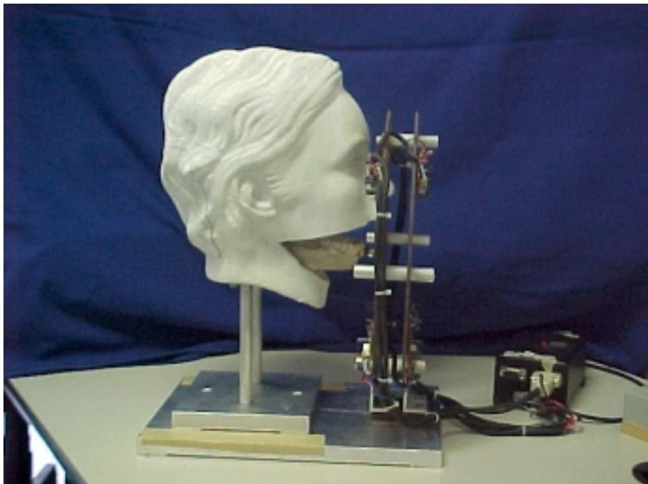
Figura 4.25 - Sistema de Medição de Movimento Mandibular - Vista lateral.
