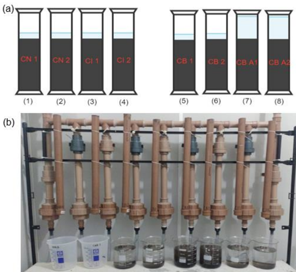
Figura 9 - (a) Esquema colunas de lixiviação, (b) Colunas de lixiviação.
