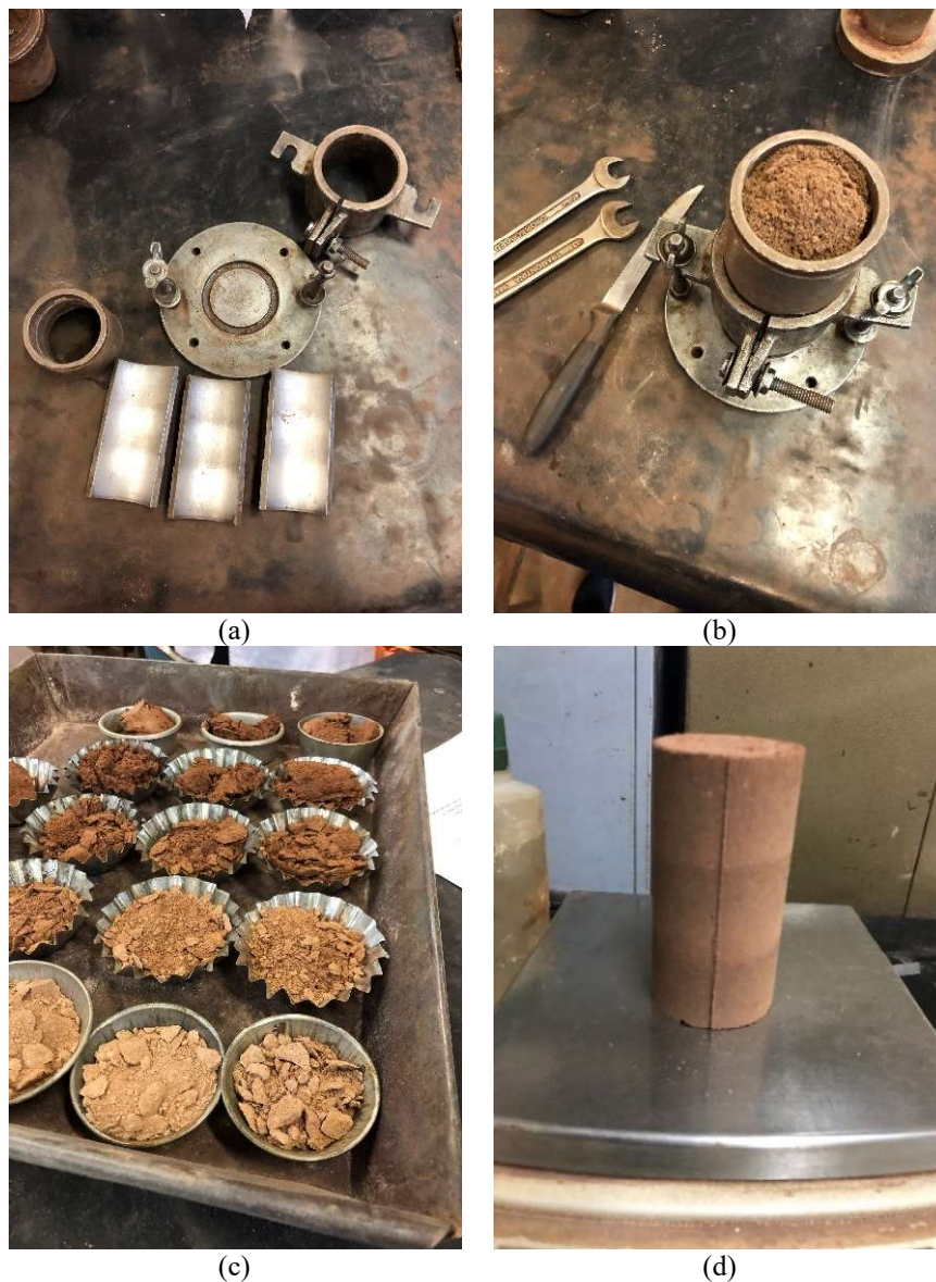
Figura 3.11 – Etapas da moldagem de corpos de prova: (a) molde tripartido (b) acondicionamento do solo no molde para compactação (c) cápsulas para medida de umidade (d) corpo de prova
