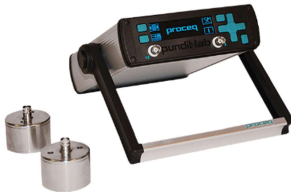
Figura 3.13 - Equipamento Pundit Lab Plus utilizado para medida de módulo cisalhante a pequenas deformações ( www.proceq.com )
