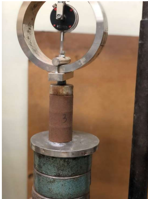
Figura 3.12 – Corpo de prova sendo ensaiado na prensa de compressão simples
