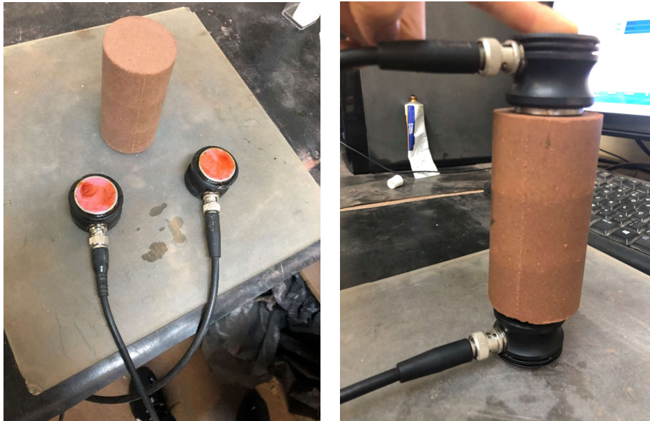
Figura 3.14 – Execução do ensaio de rigidez inicial
