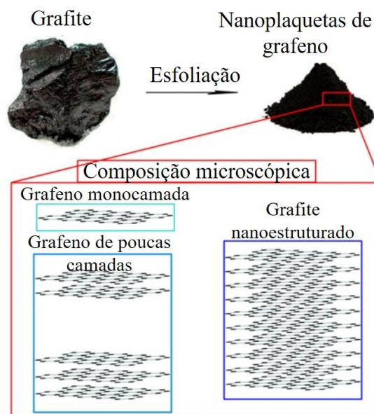
Figura 2.5 – Esquema da fabricação de GNPs a partir de grafite natural (adaptada de Cataldi et al. , 2018)
