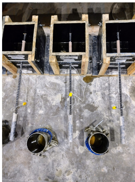
Figura 3.14 – Termopares posicionados na interface barra-concreto
