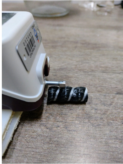
Figura 3.4 – Medição da rugosidade na superfície das barras de FRP
