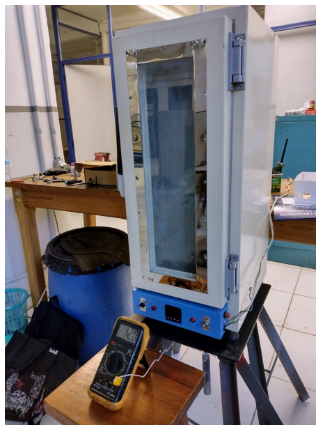
Figura 3.15 – Corpo de prova dentro do forno e leitura da temperatura na interface com o auxílio do multímetro
