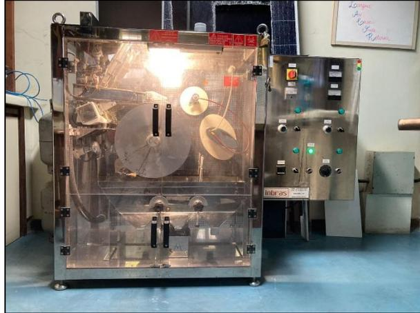
Figura 21 – Separador eletrostático de rolos, marca Imbrás, utilizado para separar materiais condutores de não-condutores da fração  $F_1$
