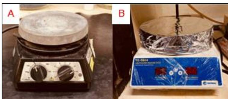
Figura 15 – A: Agitador magnético Fisatom. B: Agitador magnético Tecnal
