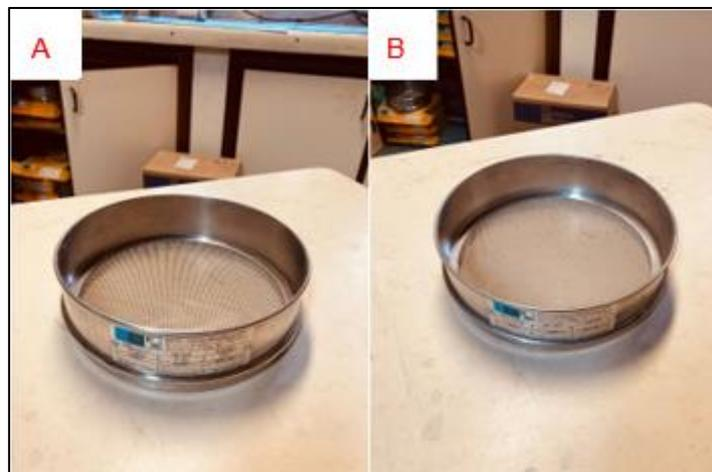
Figura 14 – Peneiras utilizadas na etapa de separação granulométrica. A: Peneira de *MESH #18*. B: Peneira de *MESH #35*
