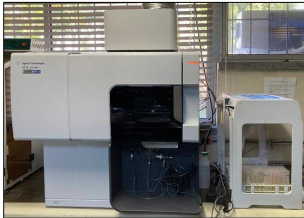
Figura 17 – Equipamento de Espectroscopia de Emissão Ótica com Plasma Individualmente Acoplado (ICP-OES), marca Aligent Technologies, série 5110
