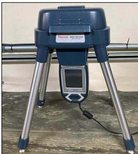
Figura 19 – Equipamento de fluorescência de raio-x (FRX), marca Thermo Scientific Niton XRF Analyzers
