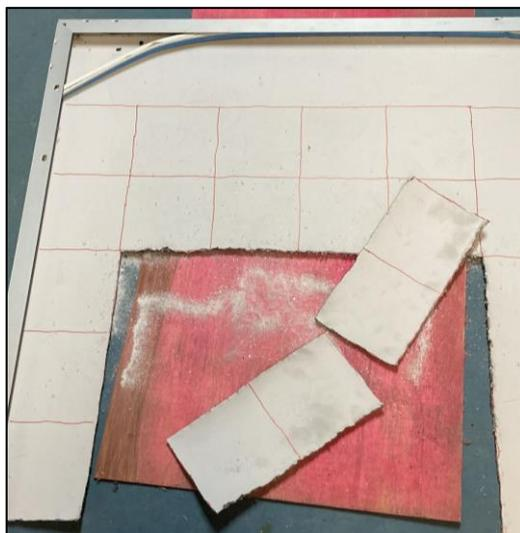
Figura 9 – Vista traseira do Painel Fotovoltaico com exemplos de amostras recortadas
