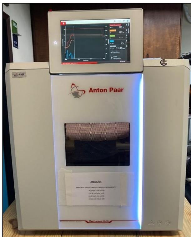
Figura 24 – Micro-ondas digestor de amostras, marca Anton Paar, utilizado nas etapas de lixiviação
