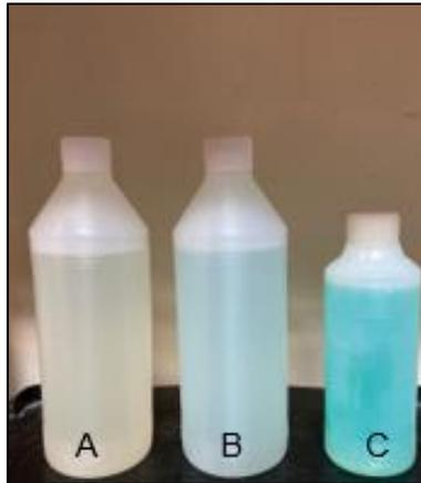
Figura 16 – Soluções obtidas na etapa de digestão com água-régia. A: F<sub>1</sub>, B:F<sub>2</sub>, C:F<sub>3</sub>
