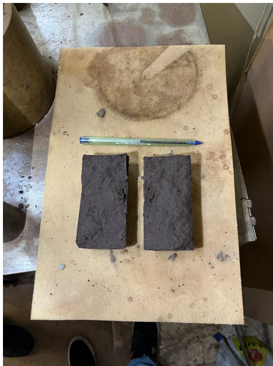
Figura 14 - Corpo de prova rompido após o Ensaio de Resistência à Compressão Diametral.
