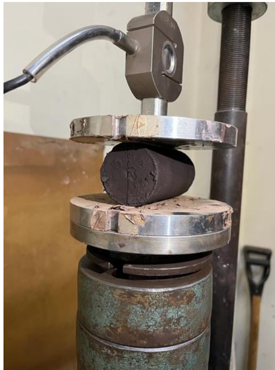
Figura 13 - Ensaio de Resistência à Compressão.
