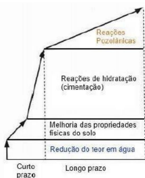
Figura 4 - Etapas do processo de estabilização do solo com cimento. (CDIT, 2002)
