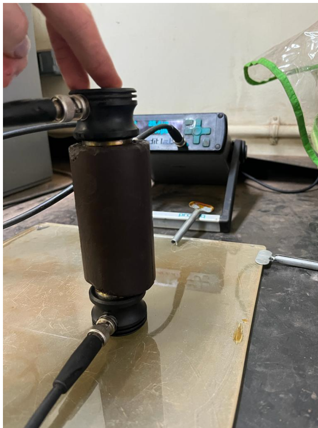
Figura 11 - Ensaio de Velocidade de Pulso.
