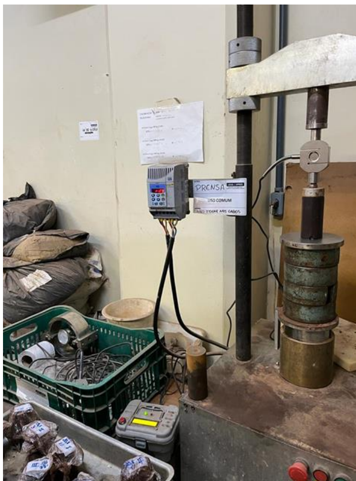
Figura 12 - Ensaio de Resistência à Compressão Simples.
