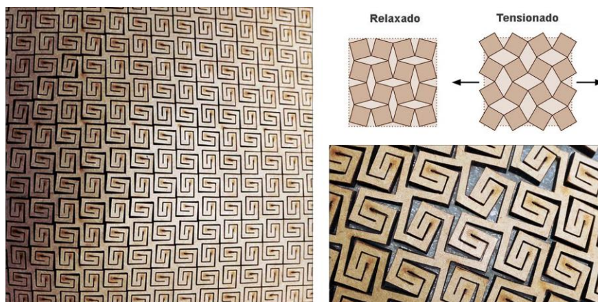
Figura 14: Padrão Kerf11: Cruz gamada ilustrando ligações auxéticas.
