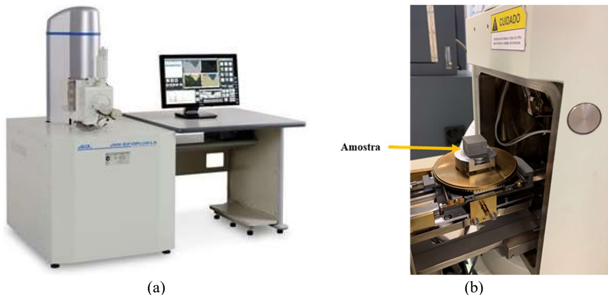
Figura 3.4 – Microscópio eletrônico de varredura: (a) MEV JEOL JSM-6010 LA ( https://forbones.org/jeol-sem ); (b) amostra posicionada no sistema de fixação.
