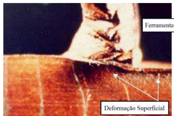
Figura 2.13 – Deformação plástica na usinagem [Astakhov, 2010].
