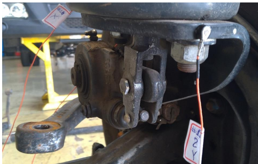
Figura 4.16 – Suporte da câmara de freio instrumentada com acelerômetros unidirecionais durante análise de extração de FRF's.
