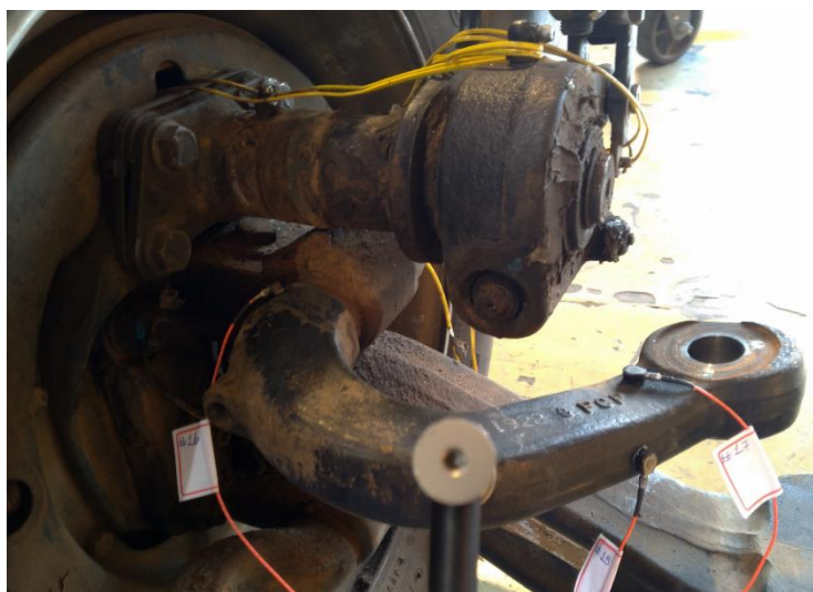
Figura 4.15 – Braço de direção instrumentado com acelerômetros unidirecionais durante análise de extração de FRF's.
