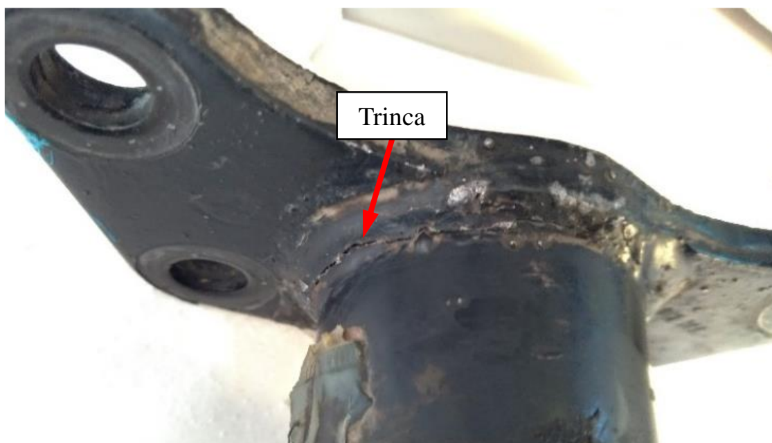
Figura 5.11 – Suporte da câmara esquerda apresentando trinca em estágio avançado.
