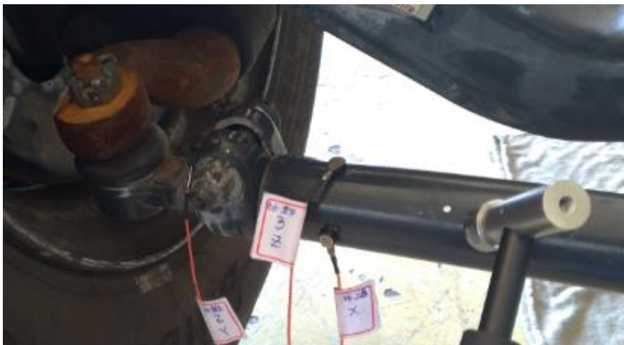
Figura 4.14 – Barra de direção transversal instrumentada com acelerômetros unidirecionais durante análise de extração de FRF's.
