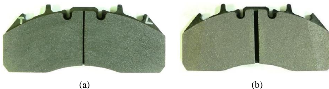
Figura 2.11 – Pastilhas de freio de veículo comercial, onde: (a) Pastilha original; (b) Pastilha modificada [Adaptada de Ergün et al., 2013].
