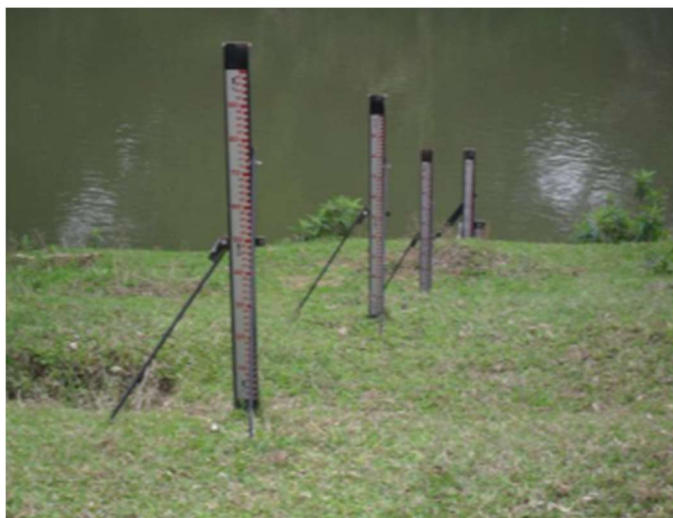
Figura 3 – Estação fluviométrica convencional.
