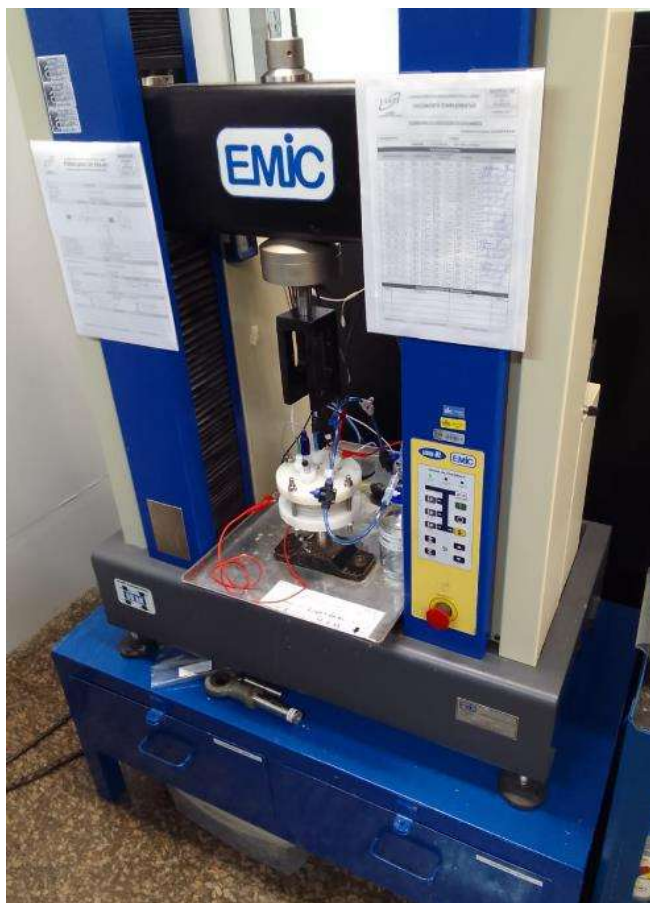
Figura 4.5 Máquina de ensaios universal EMIC com a célula eletroquímica acoplada.
