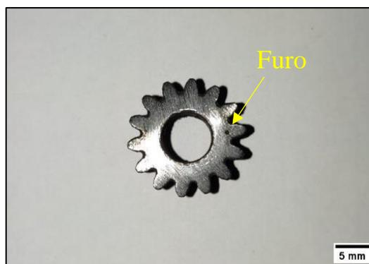
Figura 4.3 - Amostra de referência com furação para acoplamento do termopar.
