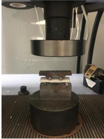
Figura 16 - Ensaio de Flexão de 4 pontos utilizado no trabalho (LACER - UFRGS). Fonte: Autor
