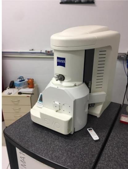
*Figura 18 - Microscopia Eletrônica de Varredura (MEV) (LACER - UFRGS). Fonte: Autor*
