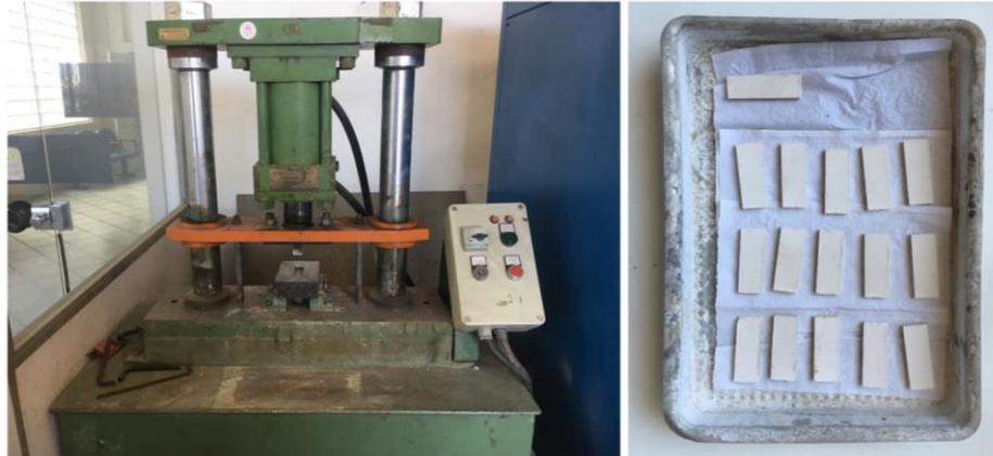
Figura 14 - Prensa hidráulica (à esquerda) utilizada na conformação dos corpos de prova (à direita) (LACER – UFRGS). Fonte: Autor.
