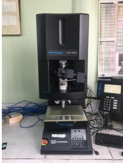
Figura 17 - Ensaio de Microdureza Vickers (LAMEF - UFRGS). Fonte: Autor
