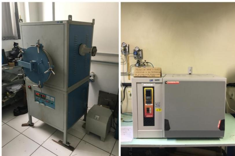
Figura 15 - Forno industrial do tipo mufla utilizado para queima à 1350°C e 1400°C (à esquerda) (LACER – UFRGS) e forno industrial Carbolite utilizado para queima à 1300°C (à direita) (LABIOMAT – UFRGS). Fonte: Autor
