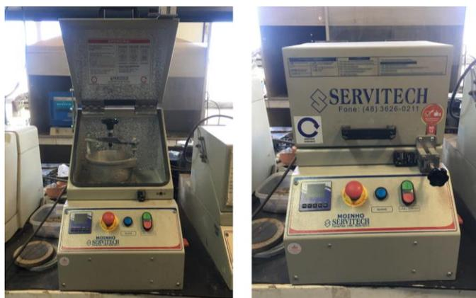
Figura 13 -Moinho tipo planetário utilizado para cominuição do isolador elétrico (LACER – UFRGS).
