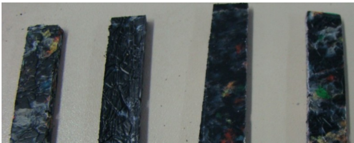
Figura 12: Amostras dos corpos de prova de algumas formulações testadas no ensaio de impacto.
