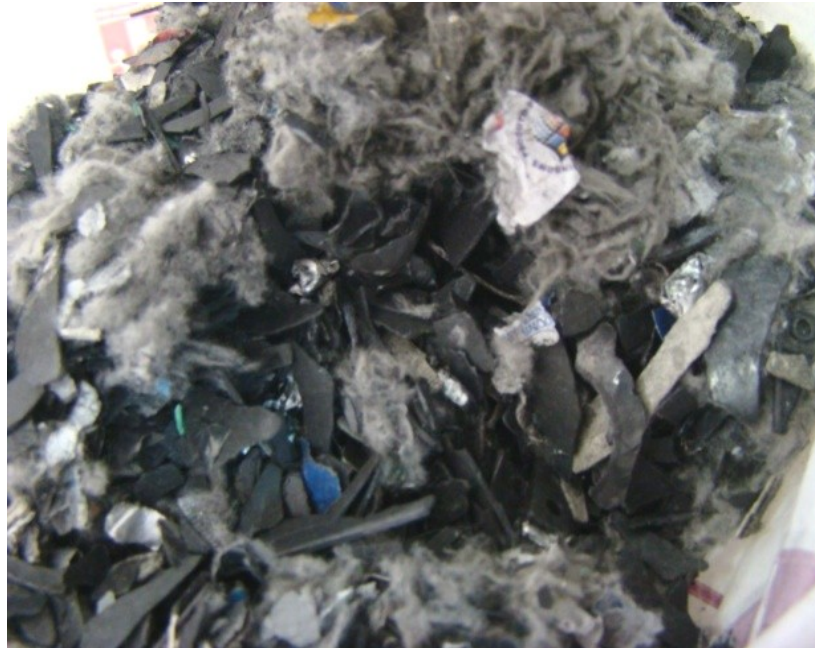
Figura 10: Imagem dos disquetes após a moagem.
