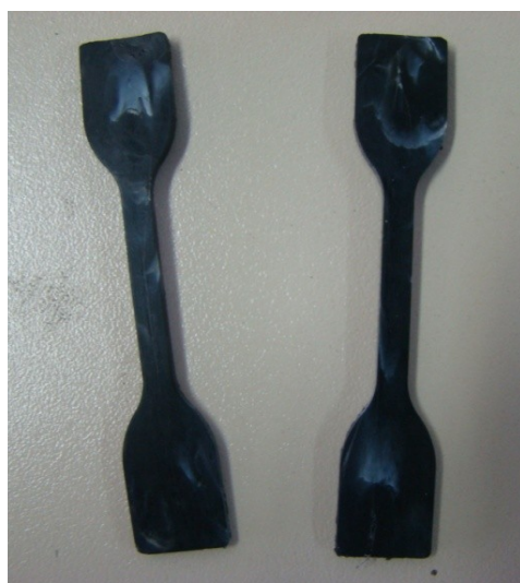
Figura 11: Corpo de prova do tipo 'gravata' usado para ensaio de tração.
