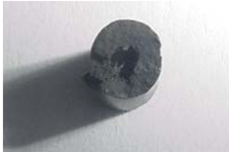
Figura 4.10 Defeito de injeção.
