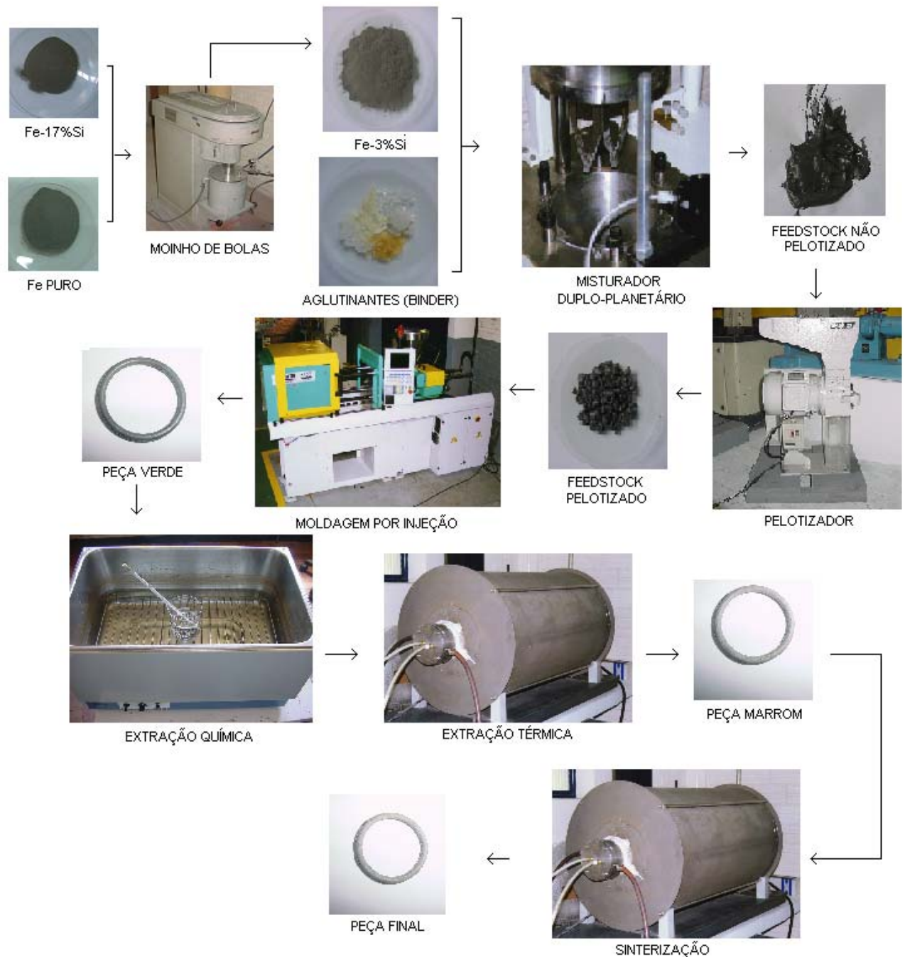
Figura 3.1 Fluxograma do procedimento experimental.
