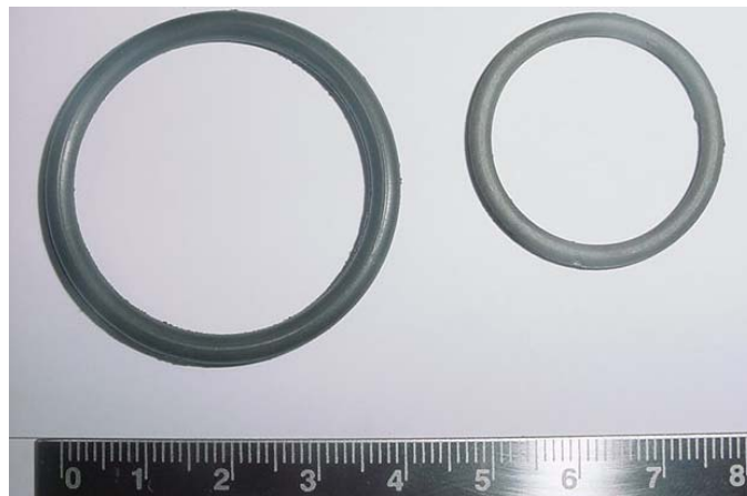
Figura 5.1 Comparação entre a peça verde e a sinterizada.
