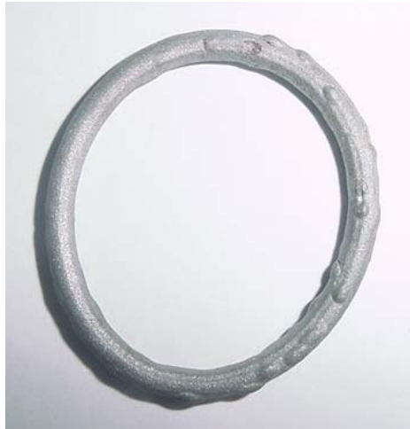
Figura 4.14 Formação de bolhas durante a extração térmica.
