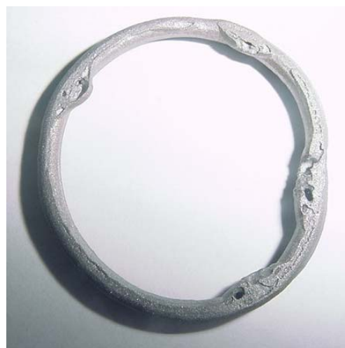
Figura 4.13 Formação de deformidades durante a extração térmica.
