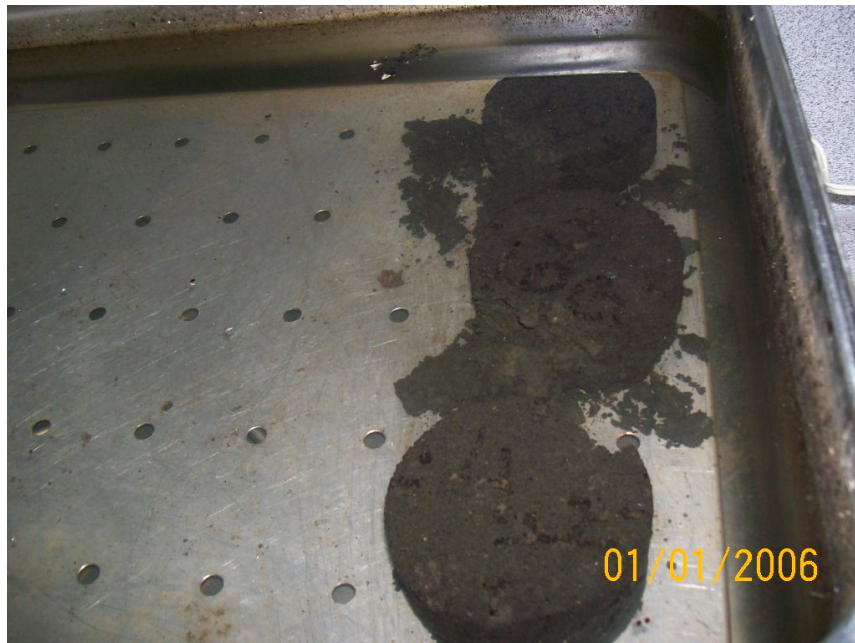
Figura 21: desintegração dos CP durante o ensaio de perda por umidade induzida
