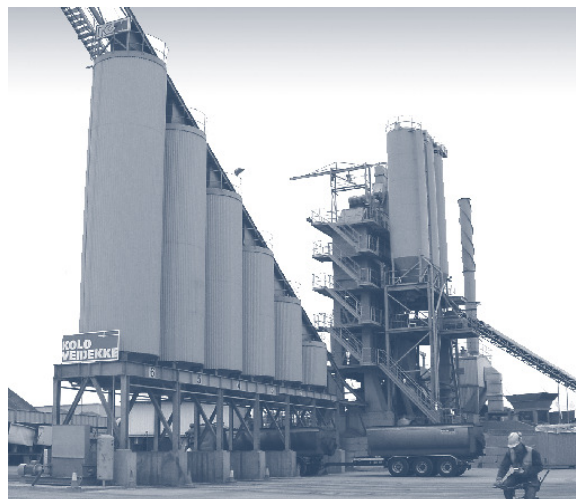
Figura 5: usina de misturas asfálticas mornas, Kolo Veidekke na Noruega (D'ANGELO et al., 2008, p. 31)
