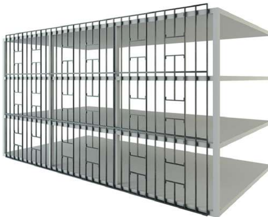
Figura 7: fechamento em LSF – Método Contínuo (SANTIAGO; ARAÚJO, 2008, p. 7)
